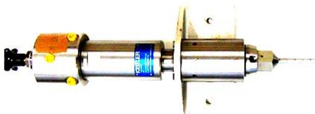
Figura 3 – Equipamento de calibração do fabricante Kistler, modelo 6905, de propriedade da Marinha
