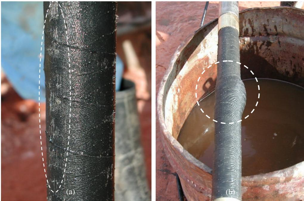
Figura 101 – Fotos de danos à membrana: (a) dano superficial na camada de reforço; (b) membrana com ruptura localizada.
