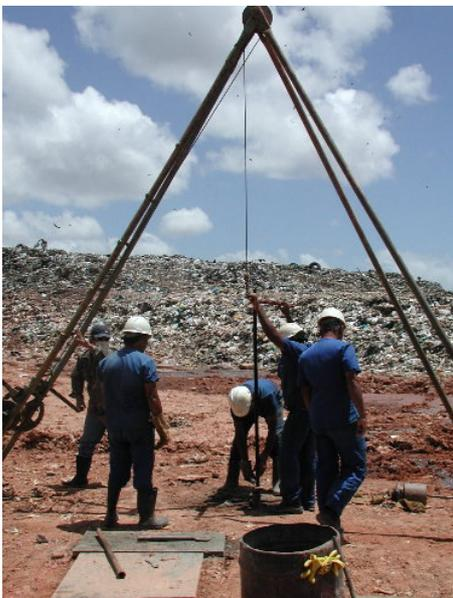
Figura 102 – Equipe realizando ensaio de SPT em RSU.
