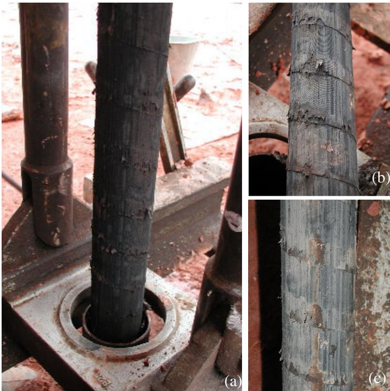
Figura 93 – Detalhes da membrana danificada após cravação direta
