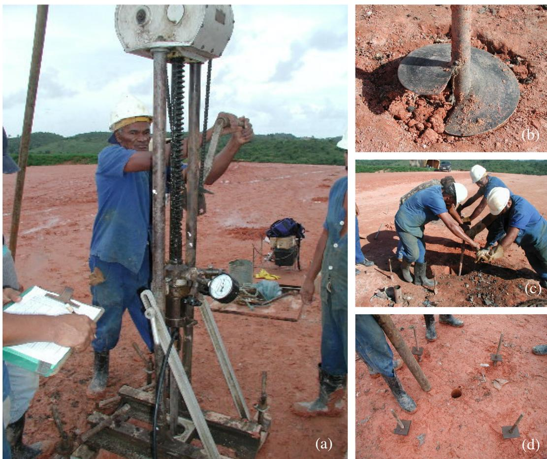
Figura 91 – Sistema de cravação do PMT usado no aterro da Muribeca: (a) cravador; (b) trado de reação; (c) fixação das reações; (d) trados fixados.
