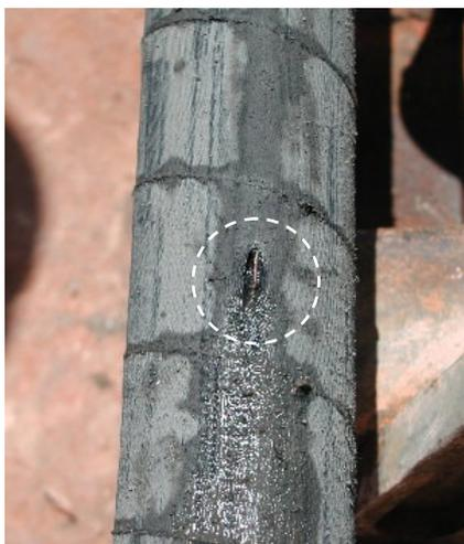
Figura 96 – Detalhe de perfuração da membrana ocorrida durante a expansão no PTM2
