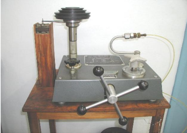
Figura 74 – Calibrador *Budenberg* para transdutores de pressão.
