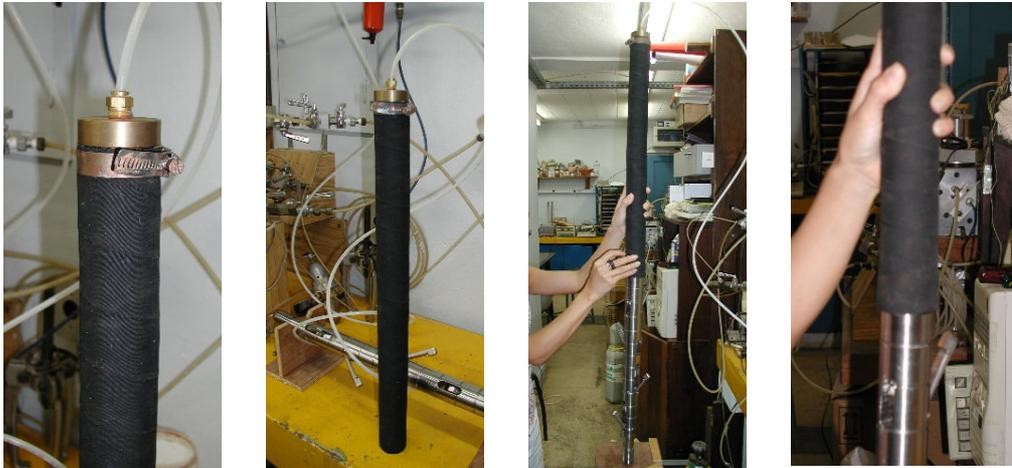
Figura 66 – Fotos do procedimento de colocação da membrana.
