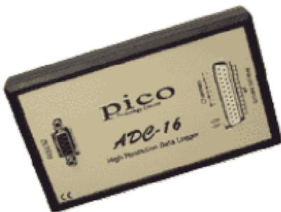
Figura 60 - Conversor analógico-digital de 8 canais usado para aquisição.
