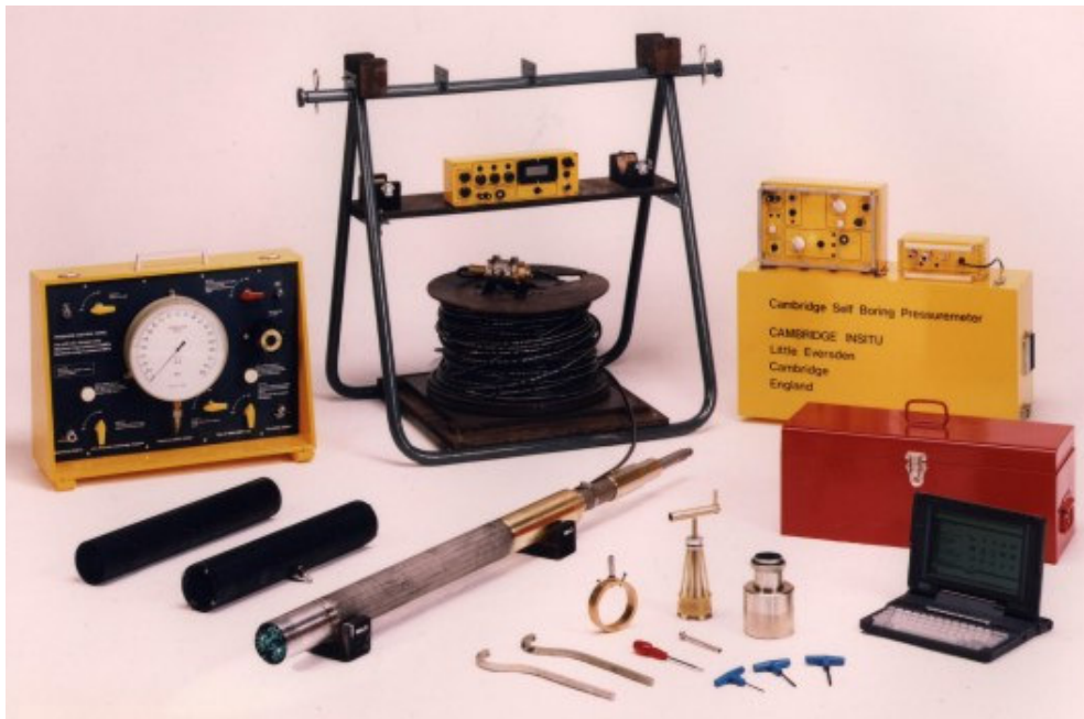
Figura 7 – Foto do PAP da Cambridge Insitu e suas partes constituintes.
