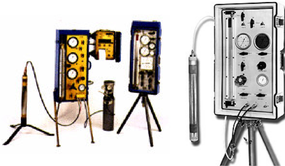
Figura 2 – Fotos de pressiômetros do tipo Mégnard e componentes.
