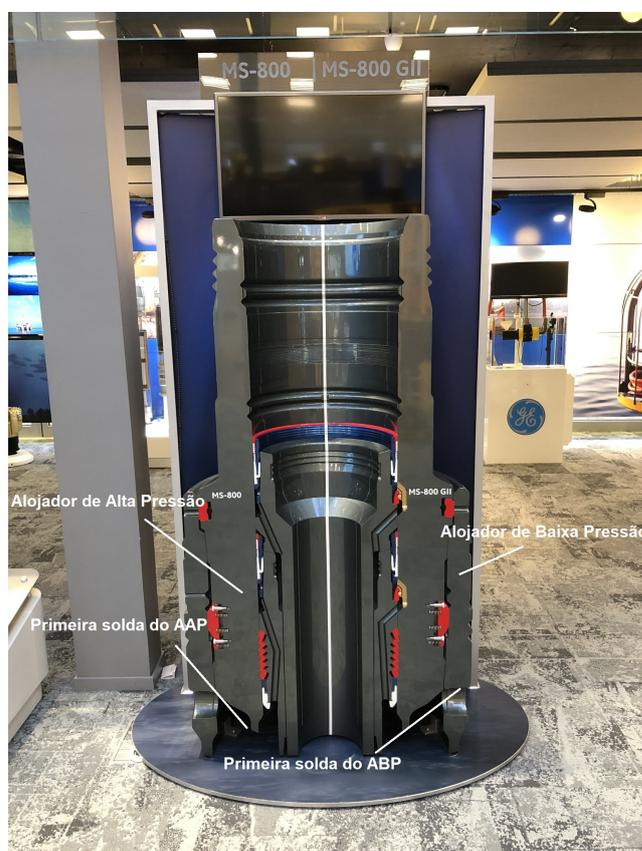
Figura 1.2: Corte de um SCPS demonstrando a montagem do conjunto [66].
