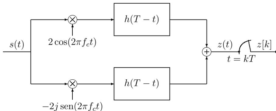
Figura A.1: Esquema de recepção para sinais com modulação em fase.
