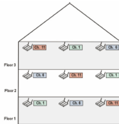
Figura 16 – topologia em frequência baseado nos canais 1, 6 e 11
