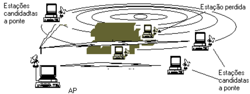
Figura 11 - AP escolhe uma estação móvel mas próxima da estação perdida para usar como ponte.
