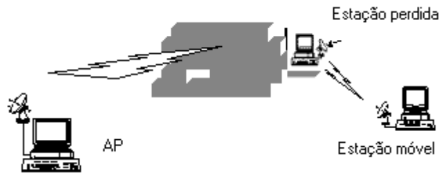
Figura 10 - Perda de conexão com a estação móvel por razão geográfica
