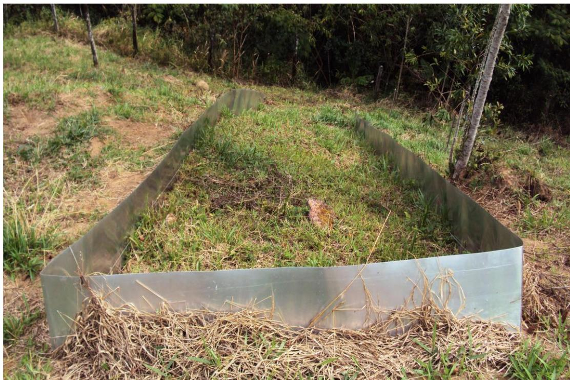
Figura 21: Definição da Área da parcela hidroerosiva de 20 m<sup>2</sup> (10m X 2m) delimitada através da fixação da chapa de alumínio no solo – Sítio Abaetetuba – Localidade Toca da Onça – Lumiar – Nova Friburgo/RJ.
