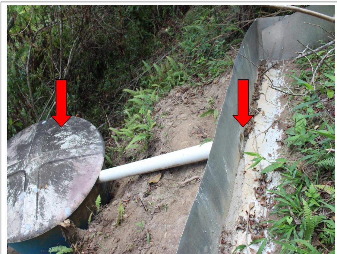
Figura 22: Foto ilustrando a parte inferior da parcela com a conexão do cano de PVC entre o orifício da calha coletora de sedimentos e a caixa d'água onde ficam armazenados a água e os sedimentos provenientes do escoamento superficial – Sítio Abaetetuba – Localidade Toca da Onça – Lumiar – Nova Friburgo/RJ.
