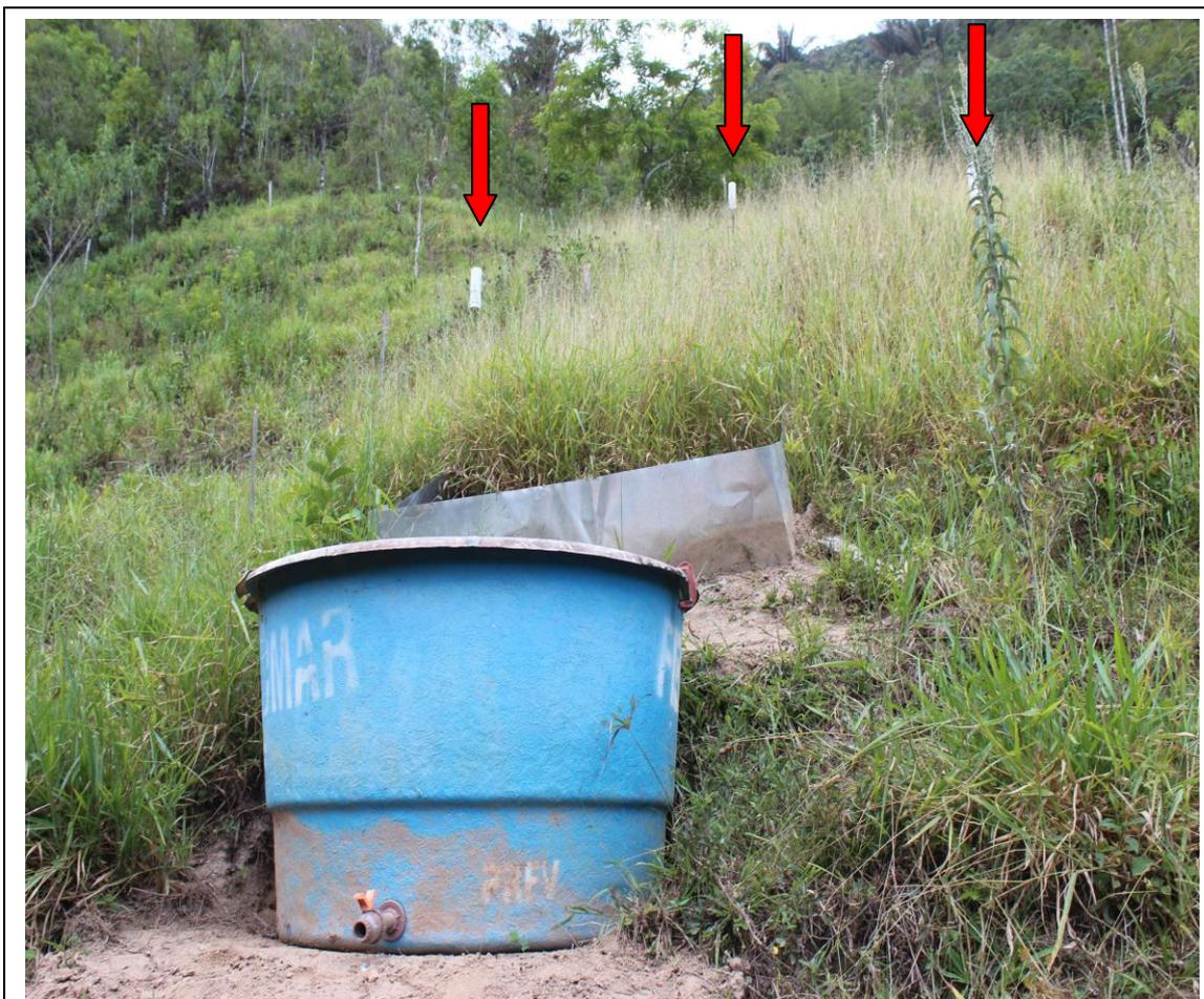
Figura 28: Demonstração da parcela hidroerosiva no campo com a indicação da distribuição dos pluviômetros ao redor para a mensuração média de precipitação diária – Sítio Abaetetuba – Localidade Toca da Onça – Lumiar – Nova Friburgo/RJ.
