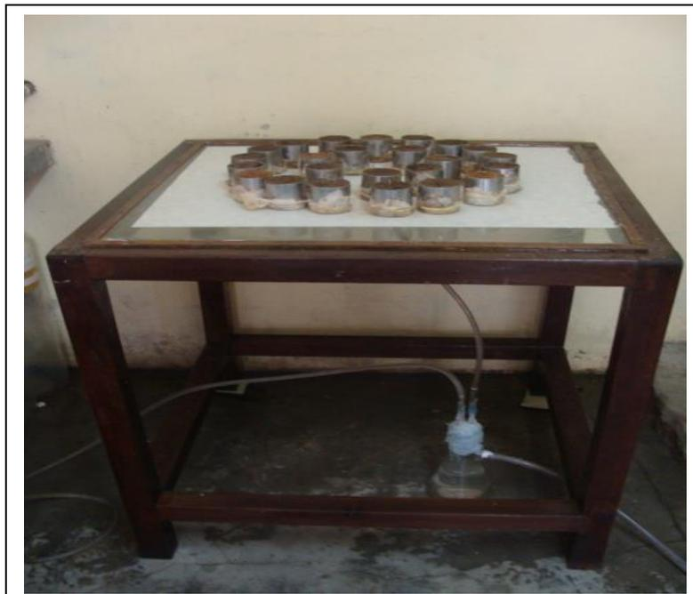
Figura 32: Mesa de tensão para onde as amostras indeformadas são levadas após a saturação para a determinação da macroporosidade e microporosidade.
