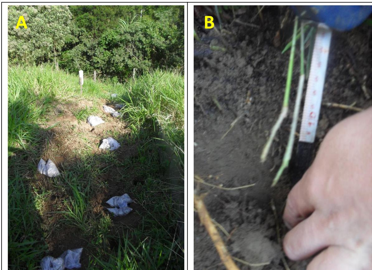
Figura 29: A - demonstração da retirada de 15 amostras deformadas nas profundidades de 0 – 5 e 5 - 10 no campo. B – Indicação da profundidade na qual foram retiradas as amostras.
