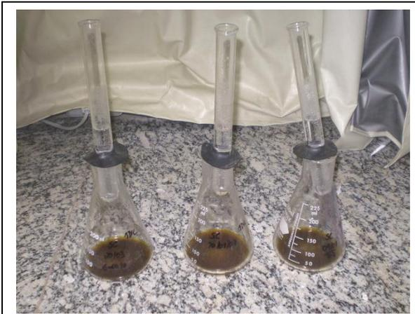
Figura 33: Solução de dicromato de potássio e sulfato de prata descansando.
