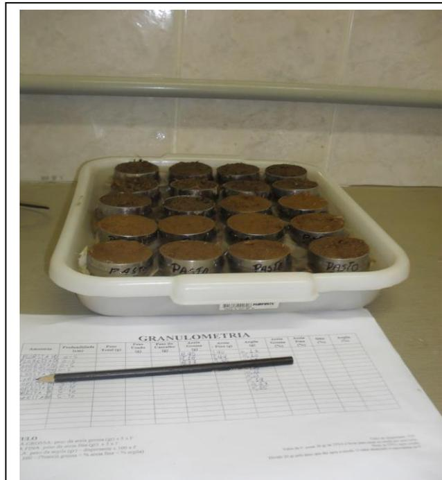
Figura 31: Amostras indeformadas sob processo de saturação antes de serem levadas para a mesa de tensão para a determinação da macroporosidade e da microporosidade.
