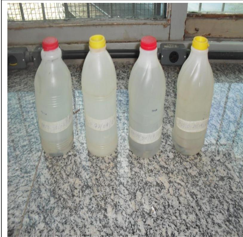
Figura 25: Alíquota de 1 Litro coletada no campo referente ao escoamento produzido a cada evento diário de chuva nas quatro parcelas hidroerosivas e levadas para procedimento de filtragem em laboratório.
