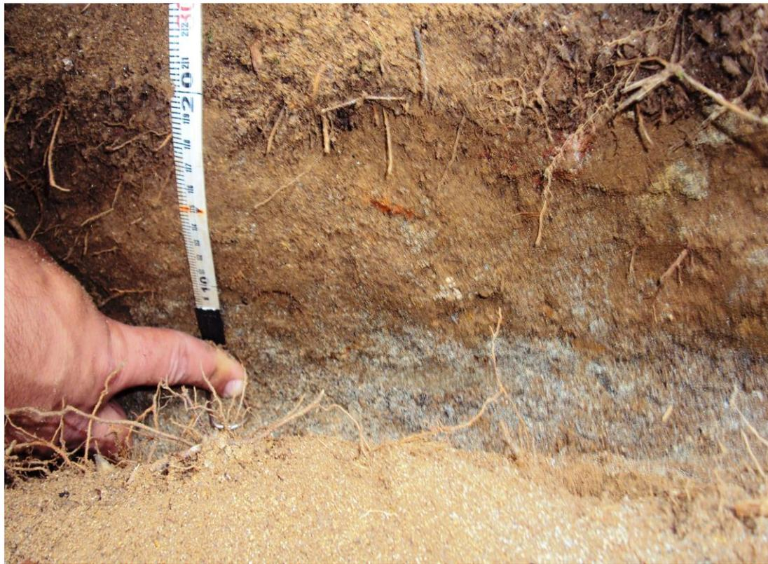
Figura 20: Indicação da profundidade de 20 cm na à qual a chapa de alumínio foi enterrada no solo para a delimitação da área da parcela – Sítio Abaetetuba – Localidade Toca da Onça – Lumiar – Nova Friburgo/RJ.
