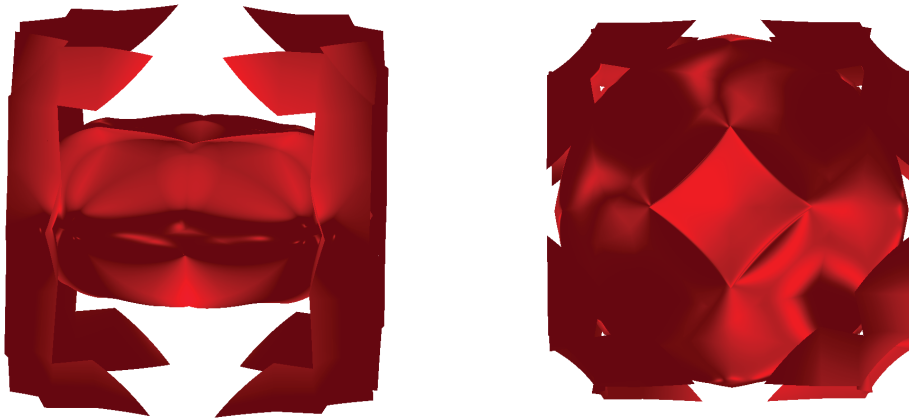
Figura 4.7: Reconstrução do modelo Cassini obtida através do caso básico: F = 0 . Observe a diversidade de artefatos indesejados que não descrevem adequadamente o comportamento dos pontos de entrada.
