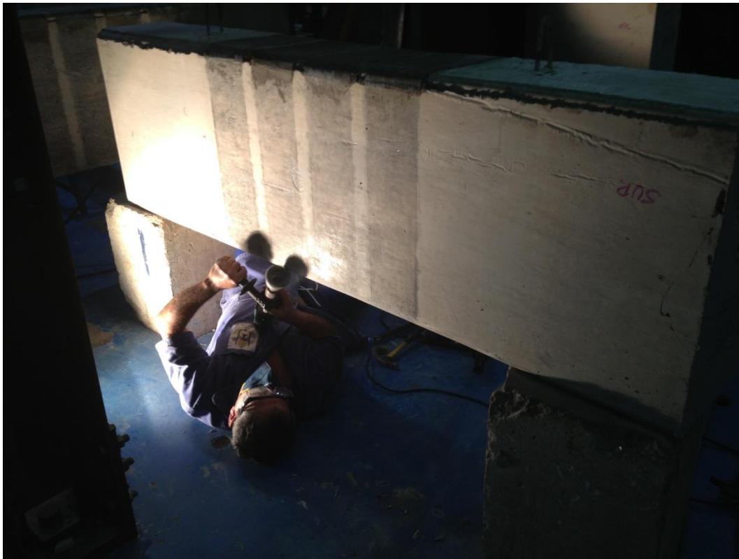
Figura A.3.3 – Lixa de fios de aço torcido para regularização dos cantos.
