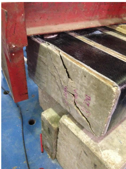
Figura A.4.5 – Viga VRB-1 após ensaio.
