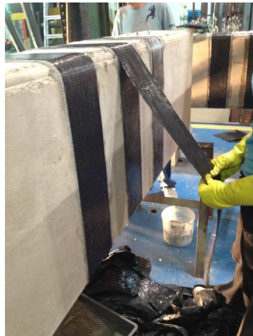
Figura A.3.4 – Aplicação da base (1209-TX) e de segunda camada do tecido de fibras de carbono.
