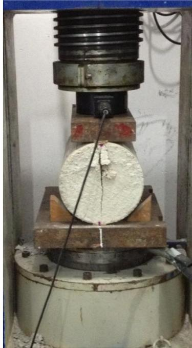
Figura 4.2 – Ensaio de compressão diametral dos corpos de prova de concreto.
