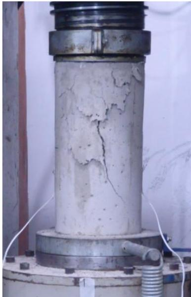
Figura 4.4 – Ensaio para determinação do módulo de elasticidade secante e a curva tensão-deformação específica dos corpos de prova de concreto.
