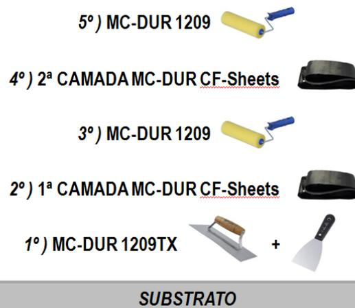
Figura 4.13 – Sequência de execução do reforço com CFC da MC-Bauchemie.
