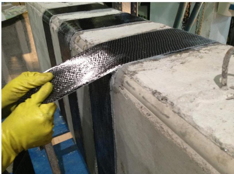
Figura 4.14 – Execução da segunda camada de reforço de uma das vigas da série RA.
