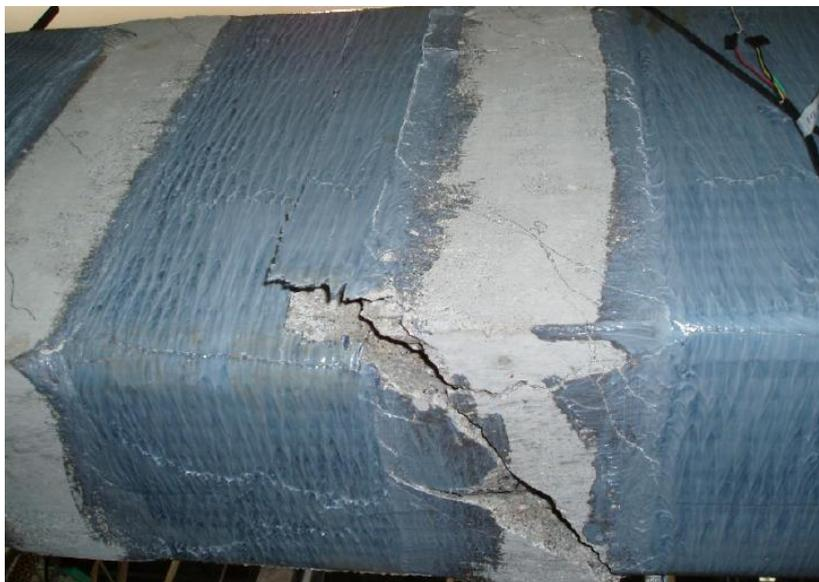
Figura 3.8 – Ruptura do reforço em viga solicitada à torção (Silva Filho, 2007).
