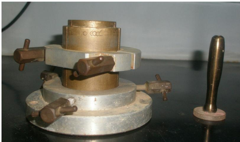
Figura 162 – Molde tripartido e haste metálica com extremidade de acrílico circular utilizados na produção de corpos de prova com material reconstituído para execução de ensaios triaxiais.
