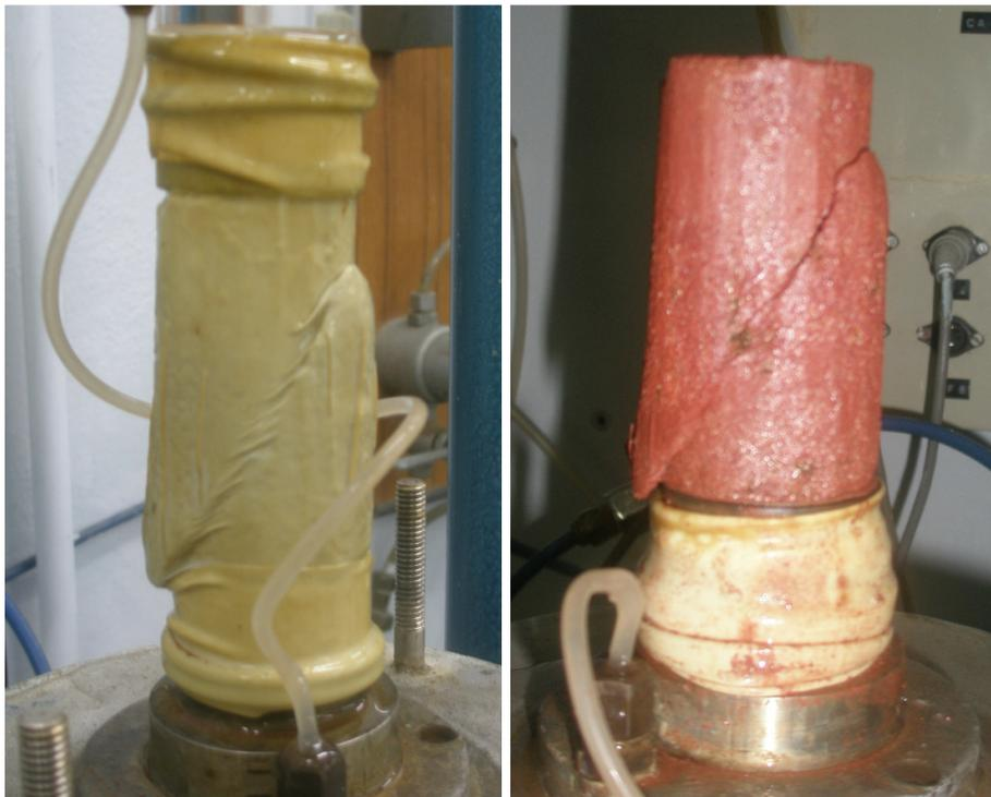
Figura 166 – Ruptura típica do solo residual DC02 indeformado: formação de plano de cisalhamento.
