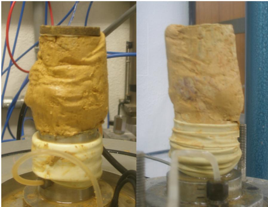
Figura 165 – Tipo de ruptura típica do solo residual T (a) Ensaio SIA-T-25 e (b) PIE-T-75
