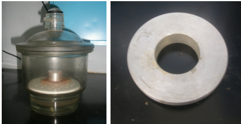
Figura 142 – a) Processo de saturação dos corpos de prova para o ensaio CRS; (b) Placa do equipamento CRS onde o corpo de prova é acomodado.
