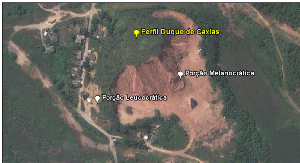
Figura 98 – Foto da área do morro onde foram coletadas amostras para determinação do perfil de alteração do migmatito de Duque de Caxias. Na imagem estão indicadas as posições das feições leucocráticas e melanocráticas identificadas.
