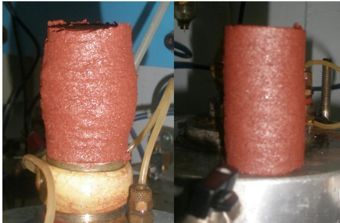
Figura 234 – Corpos de prova ao final dos ensaios CID-DC02-75R, evidenciando a ruptura tipo barril (a), e CID-DC02-300R indicando o comportamento contrátil do CP.
