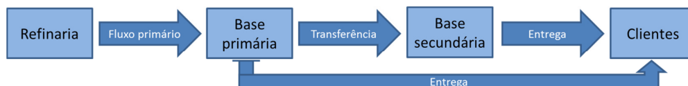
Figura 8 – Tipos de fluxos existentes na distribuição de combustíveis. Fonte: Autora, adaptado de Figueiredo (2005).
