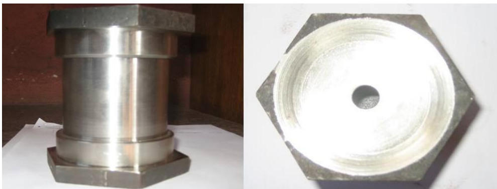
Figura 82 - Cadinho de inox e detalhe da tampa com orifício para introduzir termopar.
