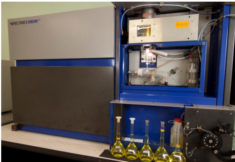
Figura 64 - ICP-OES ( Espectrômetro de Emissão Óptica por Plasma de Acoplamento Indutivo) Fabricante: Spectro Analytical Instruments Modelo: CIROS CCD N° Série: 4N / 0040.
