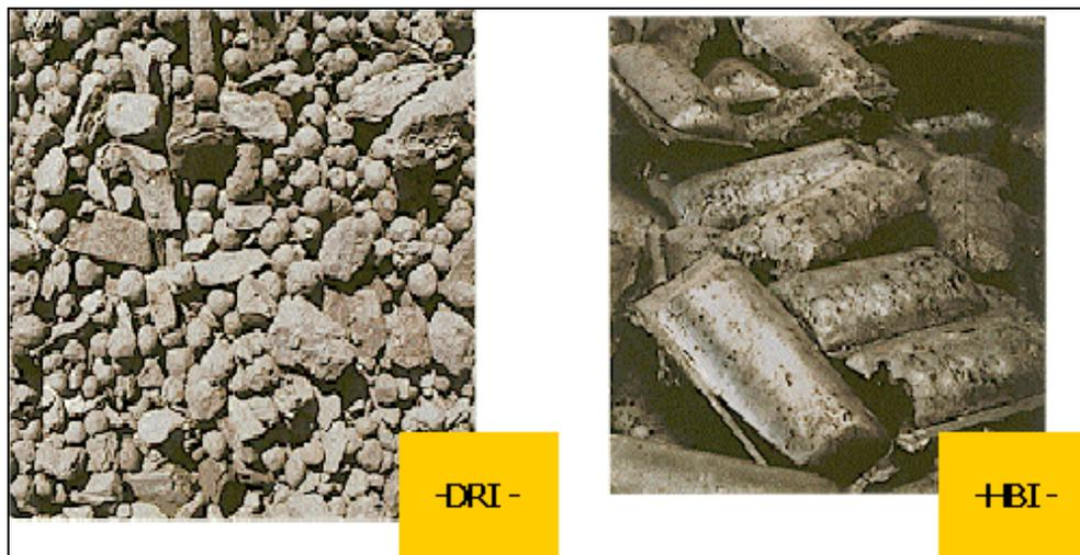
Figura 22 - Ferro-esponja granulada (DRI) e briquetado (HBI), CHELLY <sup>(apud 1)</sup>.
