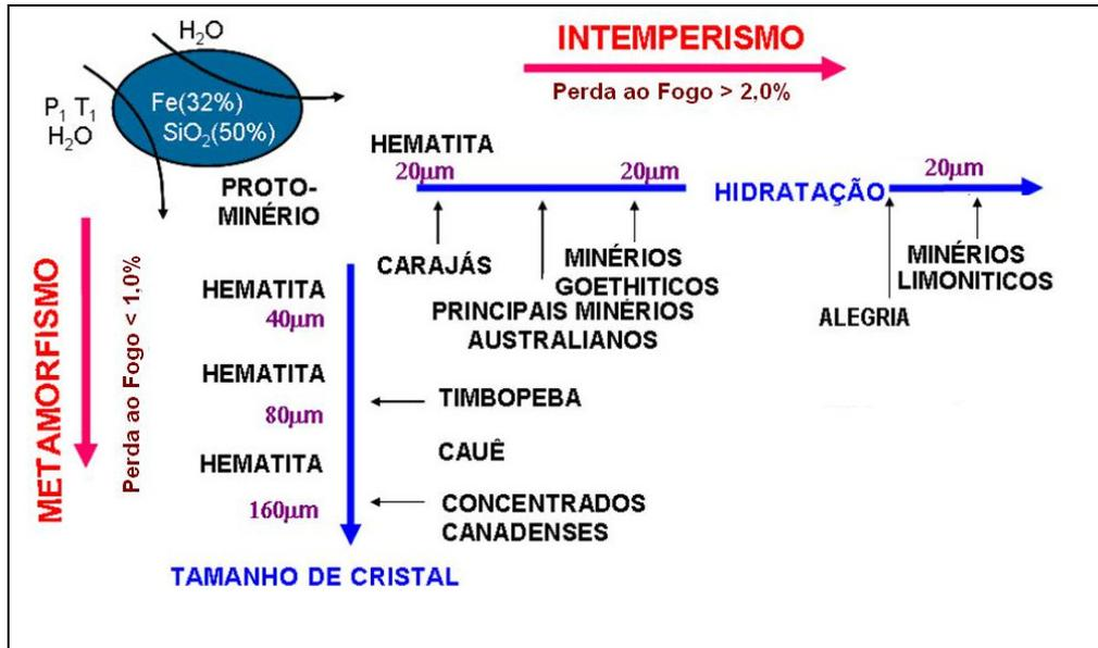
Figura 7 - Formação Mineralógica e Microestrutural de Minérios de Ferro para Pelotização <sup>(7)</sup>.
