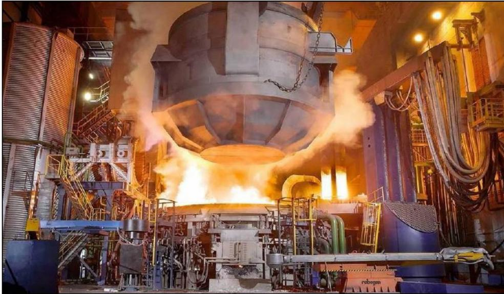
Figura 38 – Operação do carregamento por batelada de um EAF através de cestão <sup>(40)</sup>.
