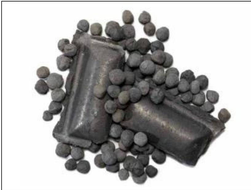
Figura 36 – Produtos pré-reduzidos: ferro esponja DRI e briquete HBI <sup>(37)</sup>.
