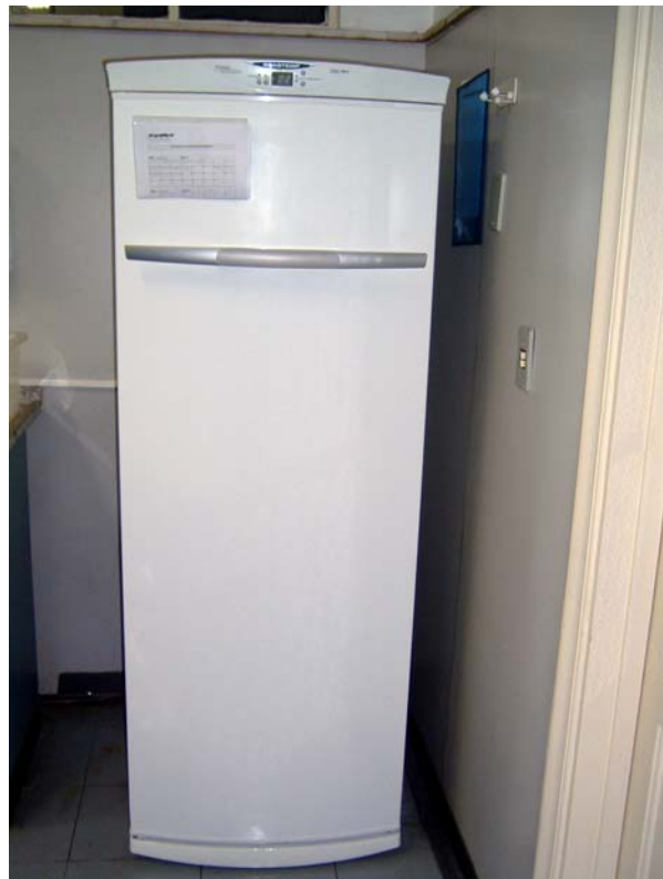
Figura 7. Câmara frigorífica para armazenagem de contraprova. -20^{\circ}\text{C} < T < -15^{\circ}\text{C} .
