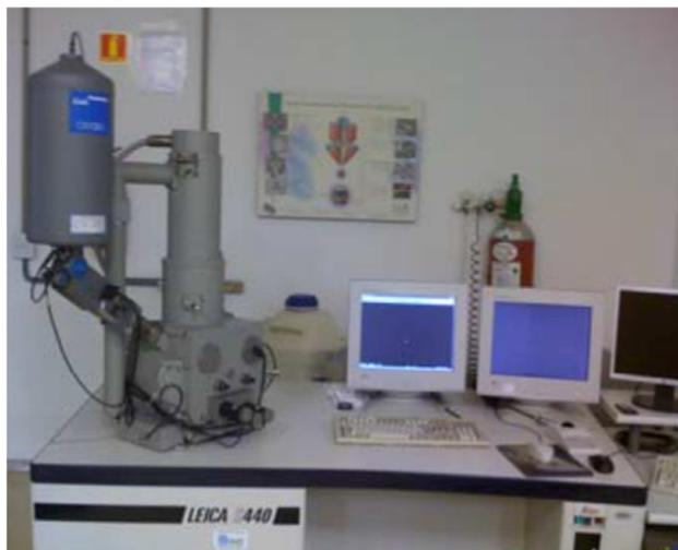
**Figura 33 - Foto do microscópio eletrônico de varredura**
