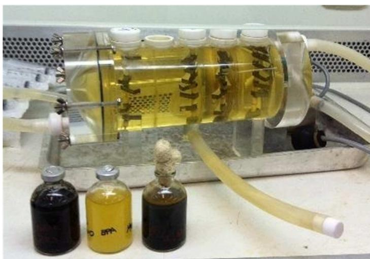
Figura 27 - Loop contendo o fluido de processo e frascos tipo antibiótico contendo as bactérias a serem inoculadas
