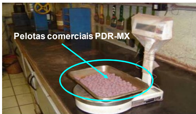
Figura 61 – Amostra de pelotas comerciais de minério de ferro tipo PDR-MX.
