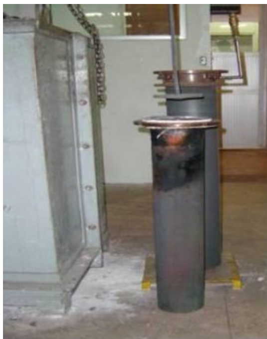
Figura 63 - Retortas cilíndricas, externa e interna, utilizadas nas experiências de redução e carburização.
