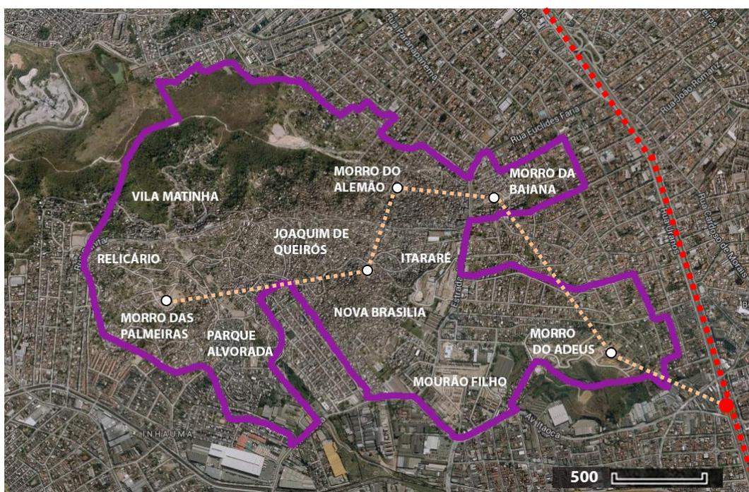
**Figura 18** - Linha do teleférico representado com suas estações e conectada à linha férrea (cor vermelha). Fonte: imagem aérea retirado Google Earth e editada pela autora.
