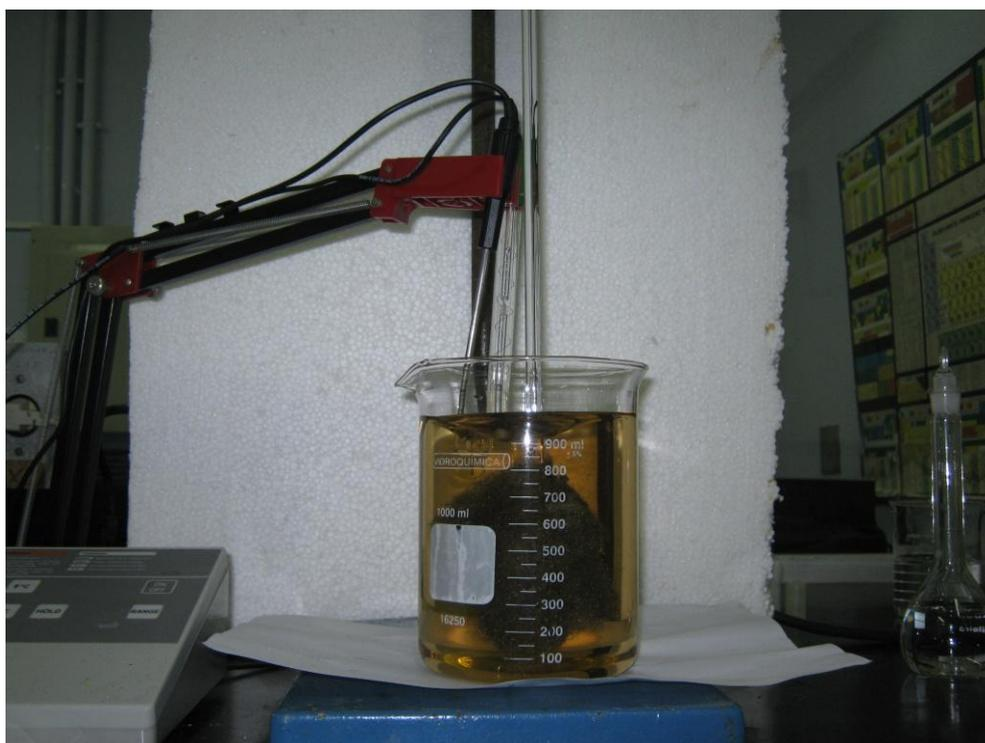
**Figura 8:** Reator montado para a degradação do fenol em efluente sintético utilizando lã de aço e peróxido de hidrogênio.
