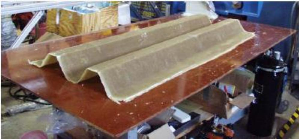
**Figura 9 – Telhas de compósito polimérico de óleo de soja e fibras vegetais (Fonte: ACRES, 2007)**
