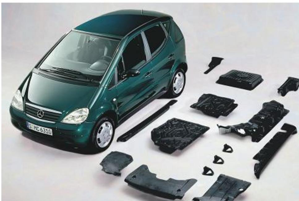
**Figura 6 – Mercedes Classe A com seus componentes internos confeccionados com compósitos poliméricos reforçados por fibras vegetais. (Fonte: MARSH 2003, cortesia da Mercedes Benz).**
