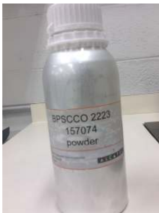
Figura 32: Pó precursor da Alcatel usado para a produção da fase 2223 para produção da fita 1G “caseira”.
