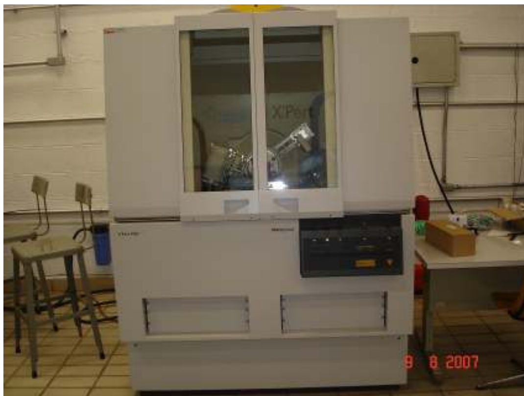
Figura 19: Difratorômetro PANALYTICAL, modelo X'PERT-PRO. CEPEL
