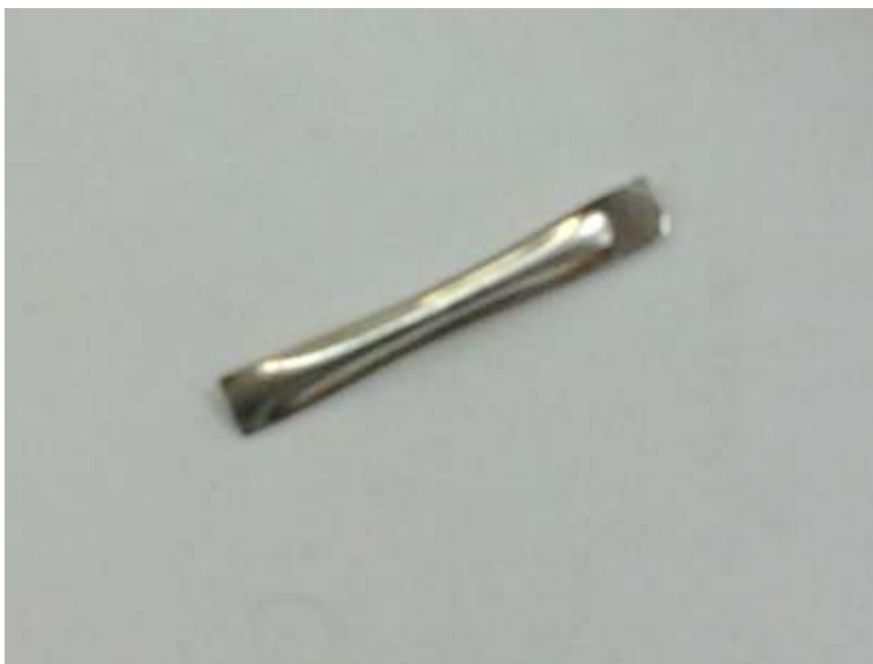
Figura 14: Fita caseira com 3 cm de comprimento com bolha- “efeito pastel”
