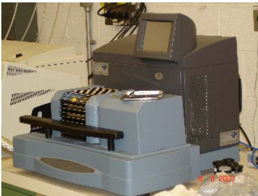
Figura 30: DTA/TGA (Análise térmica e gravimétrica)- Fabricante TA Instruments, modelo DTA100, instalado no CEPEL.
