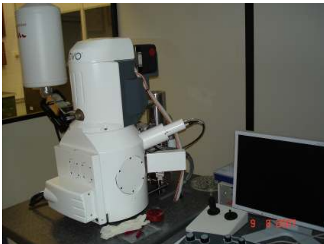
Figura 18: MEV (Microscópio Eletrônico de Varredura) ZEISS, modelo EVO 40. CEPEL
