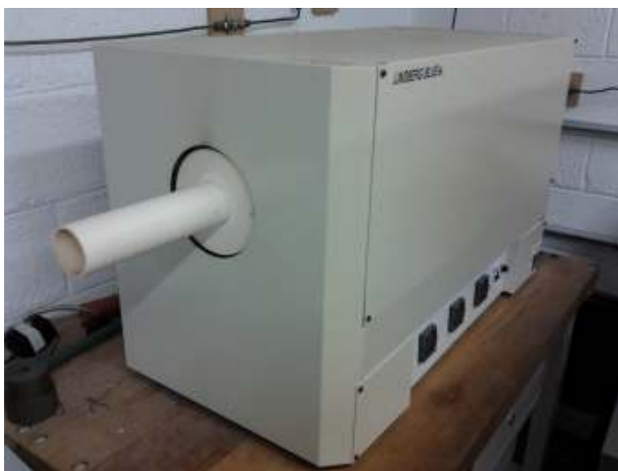
Figura 29: Forno tubular da marca LINDEBERG, modelo BLUEM. Temperatura máxima de trabalho é de 1100°C.
