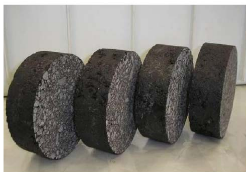
(b) Corpos-de-prova faceados
