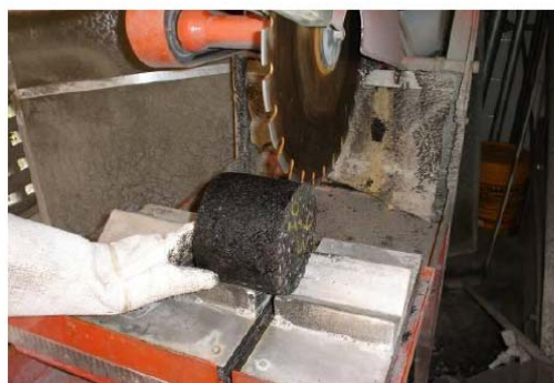
(a) Corte das faces do corpo-de-prova
