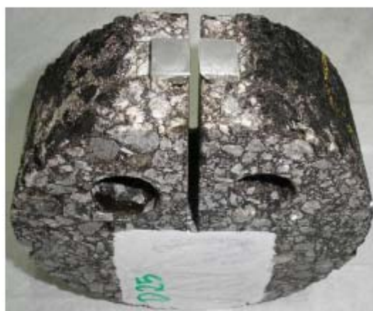
(b) Detalhe da placas coladas na amostra
