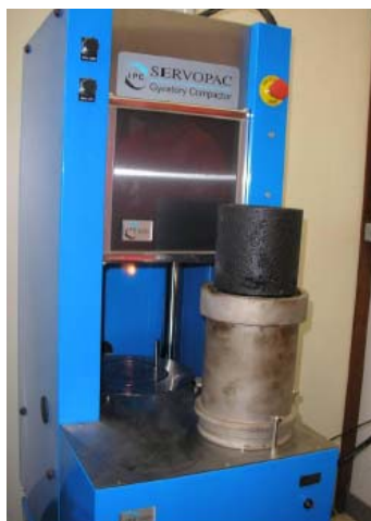
Figura 4.2 - Compactador giratório utilizado na moldagem dos corpos de prova no Laboratório de Pavimentação da COPPE/UFRJ (Hirsch,2009).
