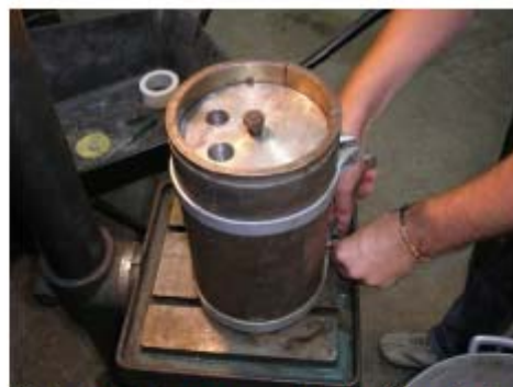
(d) corpo-de-prova e gabarito fixo dentro do molde – peça única
