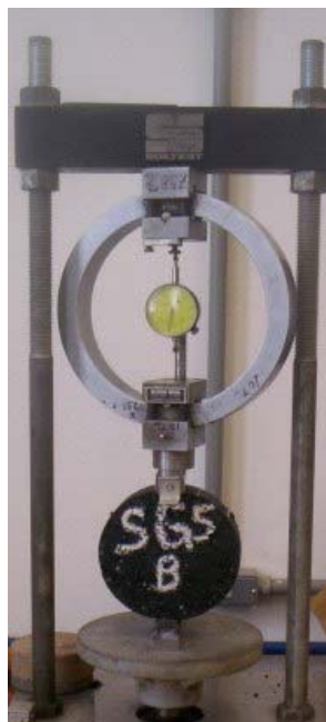
Figura 4.10 - Equipamento para ensaio de resistência à tração estática (Bastos, 2010).
