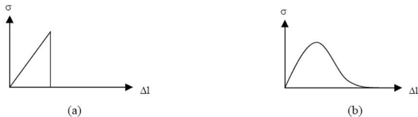
Figura 3.8 – Comportamento do material em ensaio de ruptura sob deformação controlada (a) material frágil (b) material dúctil (Soares,1997)
