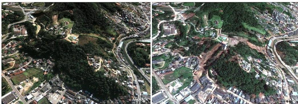
Figuras 58 e 59: Exemplo de ocupação em topo de morro como agravante à susceptibilidade de deslizamento, antes e depois das chuvas de janeiro. Fonte: *Google Earth* 07/08/2010 e 19/01/2011.
