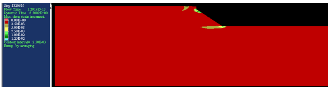
Figura 7.39 – Distribuição das deformações cisalhantes máximas no tempo t = 6.5s
