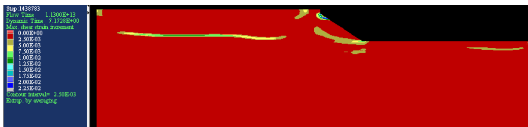
Figura 7.66 – Distribuição das deformações cisalhantes máximas no tempo t = 7s
