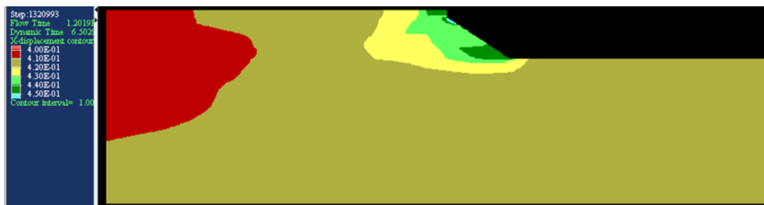
Figura 7.35 – Distribuição de deslocamentos horizontais no tempo t = 6.5s (unidade m).
