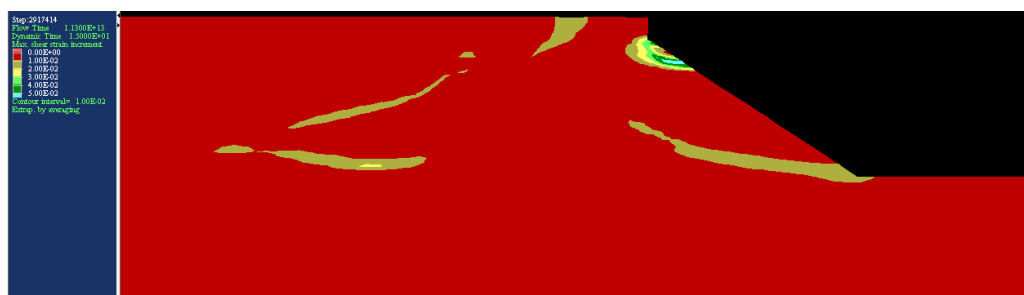
Figura 7.67 – Distribuição das deformações cisalhantes máximas no tempo t = 15s
