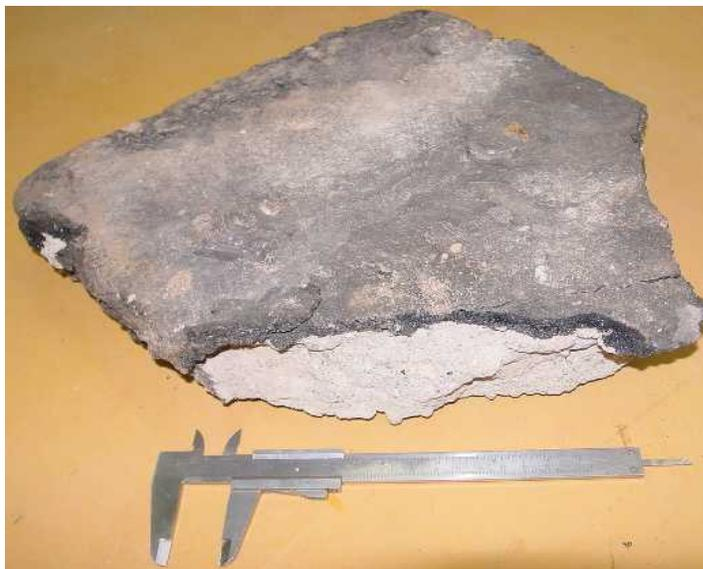
Figura 64 – Ensaio 03, placa em concreto contaminadas por óleo
