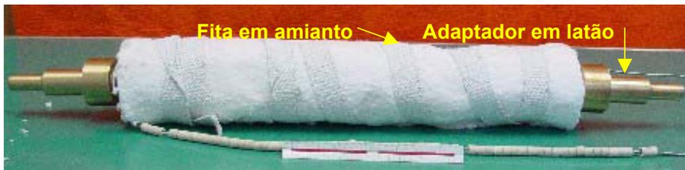
Figura 38 - Aquecedor revestido com fibra cerâmica fixada com fita de amianto (lateral).
