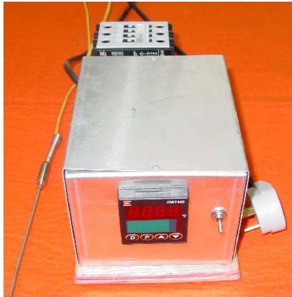
Figura 41 – Controlador de temperatura do oxidador térmico.
