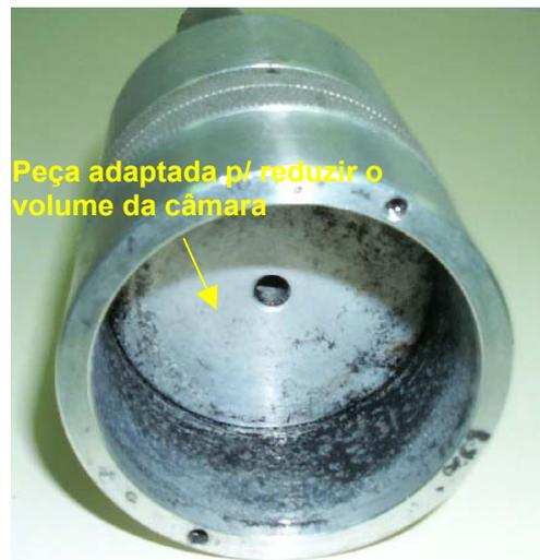
Figura 33 – Câmara de carvão ativado adaptado para amostragem de gases.
