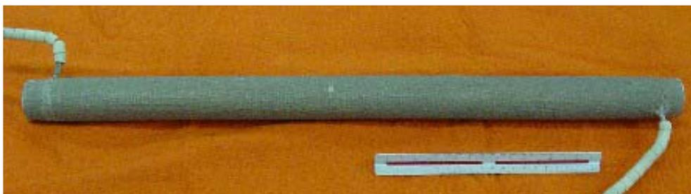
Figura 35– Aquecedor (tubo em alumina revestido com resistência).
