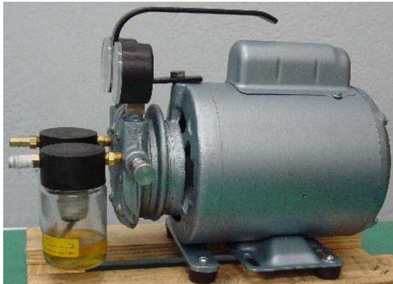
Figura 34 – Bomba a vácuo.
