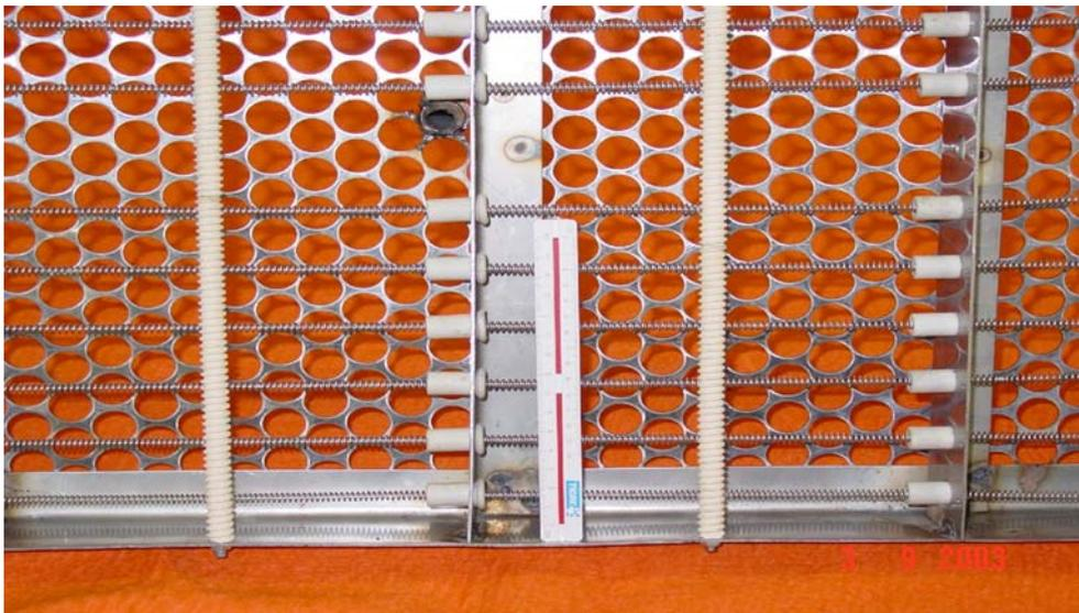
Figura 22 – Detalhe das resistências e isolantes refratários do cobertor térmico.
