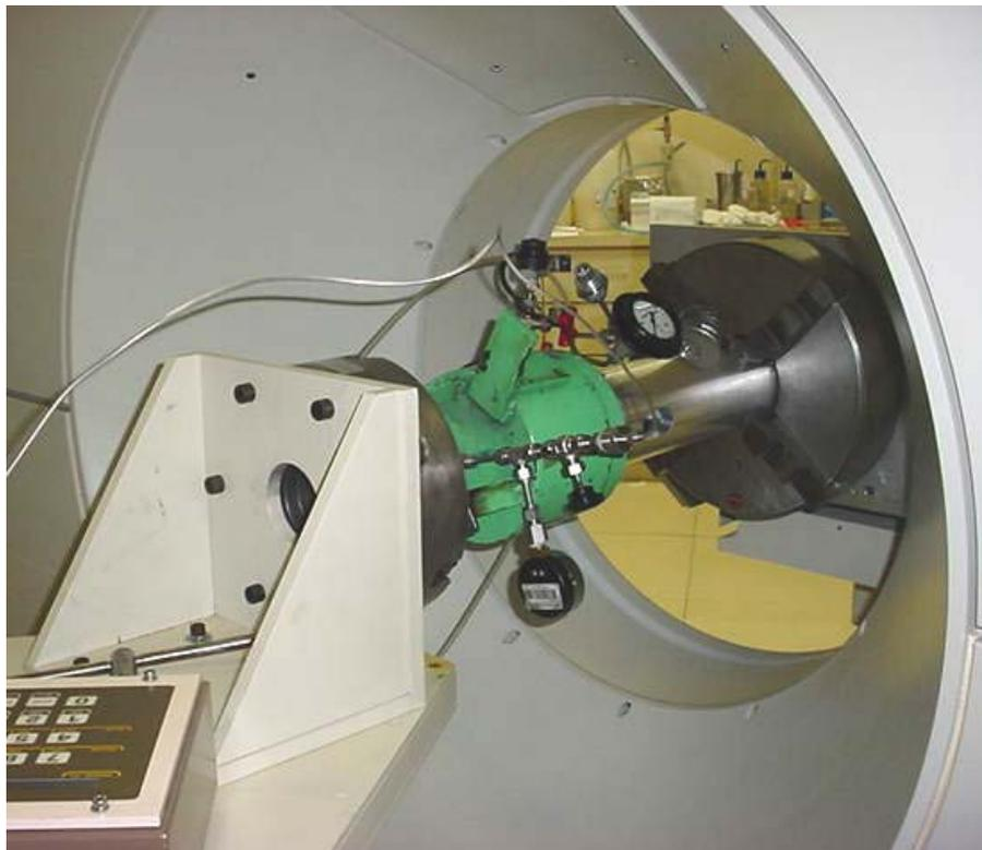
Figura 3.07 – Posicionamento da célula triaxial na mesa do tomógrafo.
