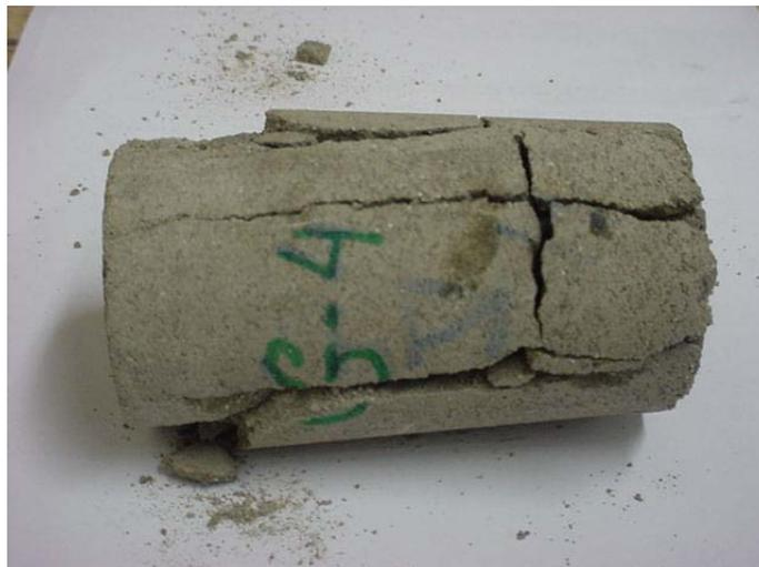
Figura 3.18 - Foto do corpo de prova G-4 após o ensaio.
