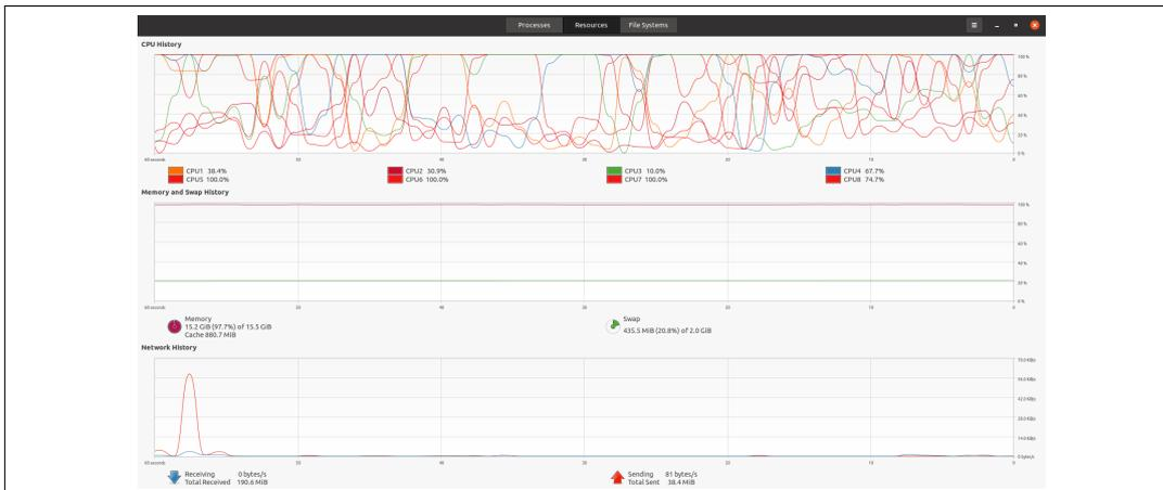
Figura 6.1: Monitorização da memória RAM utilizada pela máquina durante a otimização do modelo de Dantzig-Wolfe MIP pelo Gurobi com as colunas geradas e as colunas enumeradas. A memória RAM utilizada ultrapassa 15 GB, causando a interrupção do experimento após um tempo.
