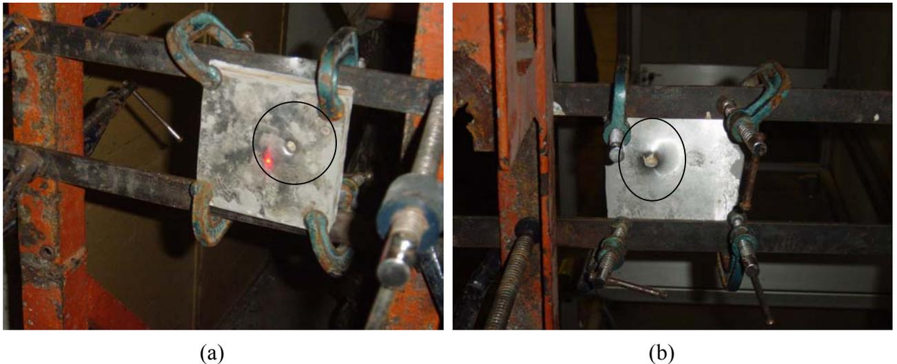
Figura 6.43 – BLCA após ser perfurado. (a) orifício de entrada e (b) saída do projétil.
