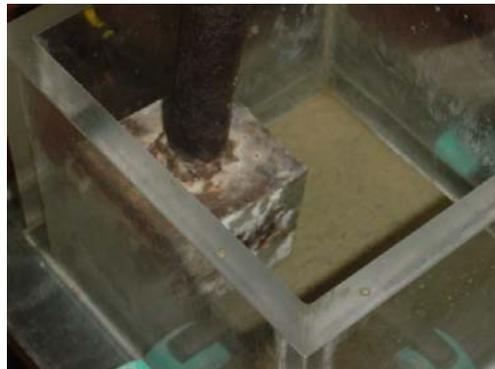
Figura 5.3 – Regularização da superfície do compósito com auxílio de soquete metálico.
