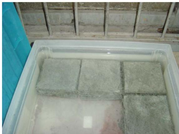
Figura 5.7 – Compósitos de sisal em cura na água.
