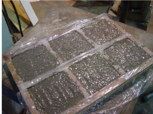
Figura 5.6 – Forma preenchida por argamassa reforçada por fibras de sisal.
