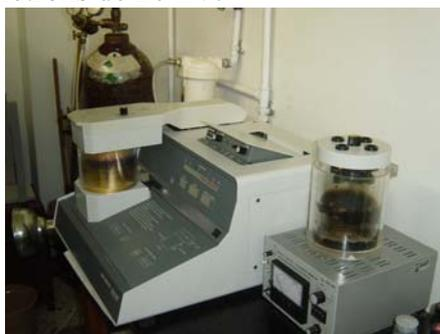
Figura 5.19 – Evaporadora Balzers SCD 050.
