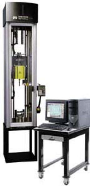
Figura 4.5 – Equipamento para ensaio de queda de peso instrumentado.
