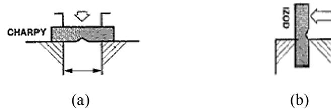
Figura 4.1 – Diferença entre ensaio de impacto (a) Charpy e (b) Izod.
