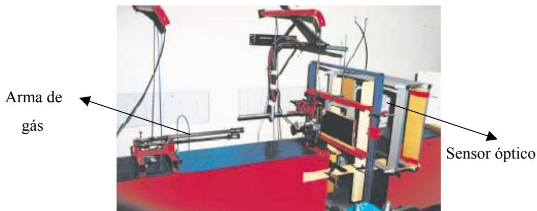
Figura 4.8 – Aparato utilizado em um teste de impacto balístico. (Larsson e Svensson, 2002)
