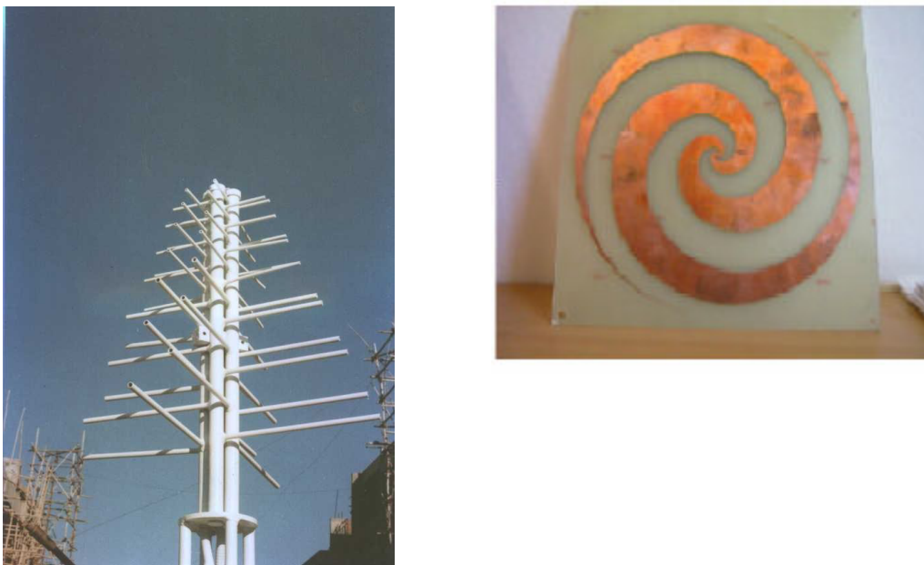
Figura 2.1 - Exemplo de antena log-periódica e antena equiangular.
