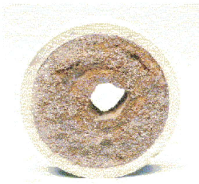
Figura 1.1: Exemplo de uma Linha Bloqueada por Depósito de Parafina (Cortesia do CENPES/Petrobras).
