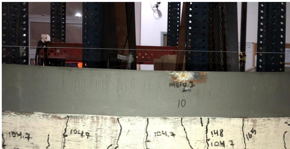
Figura 6.19 - Marcas na pintura do aço indicando a plastificação da mesa na região central.
