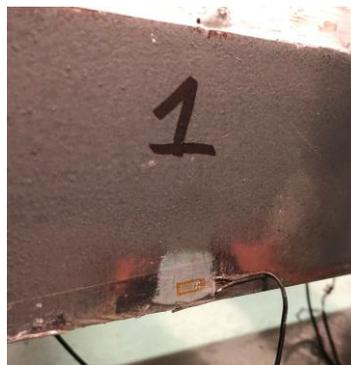
**Figura 4.20 - Extensômetro posicionado na mesa do perfil de aço.**
