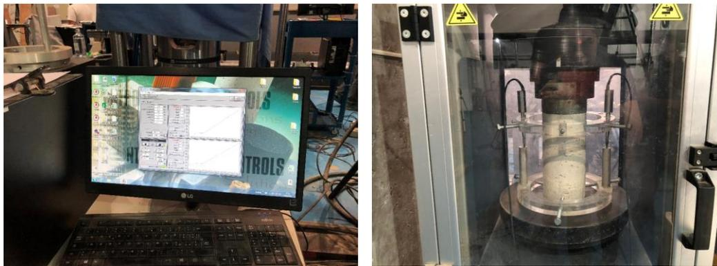
Figura 4.13 - Ensaio de compressão em corpos de prova cilíndricos de concreto.
