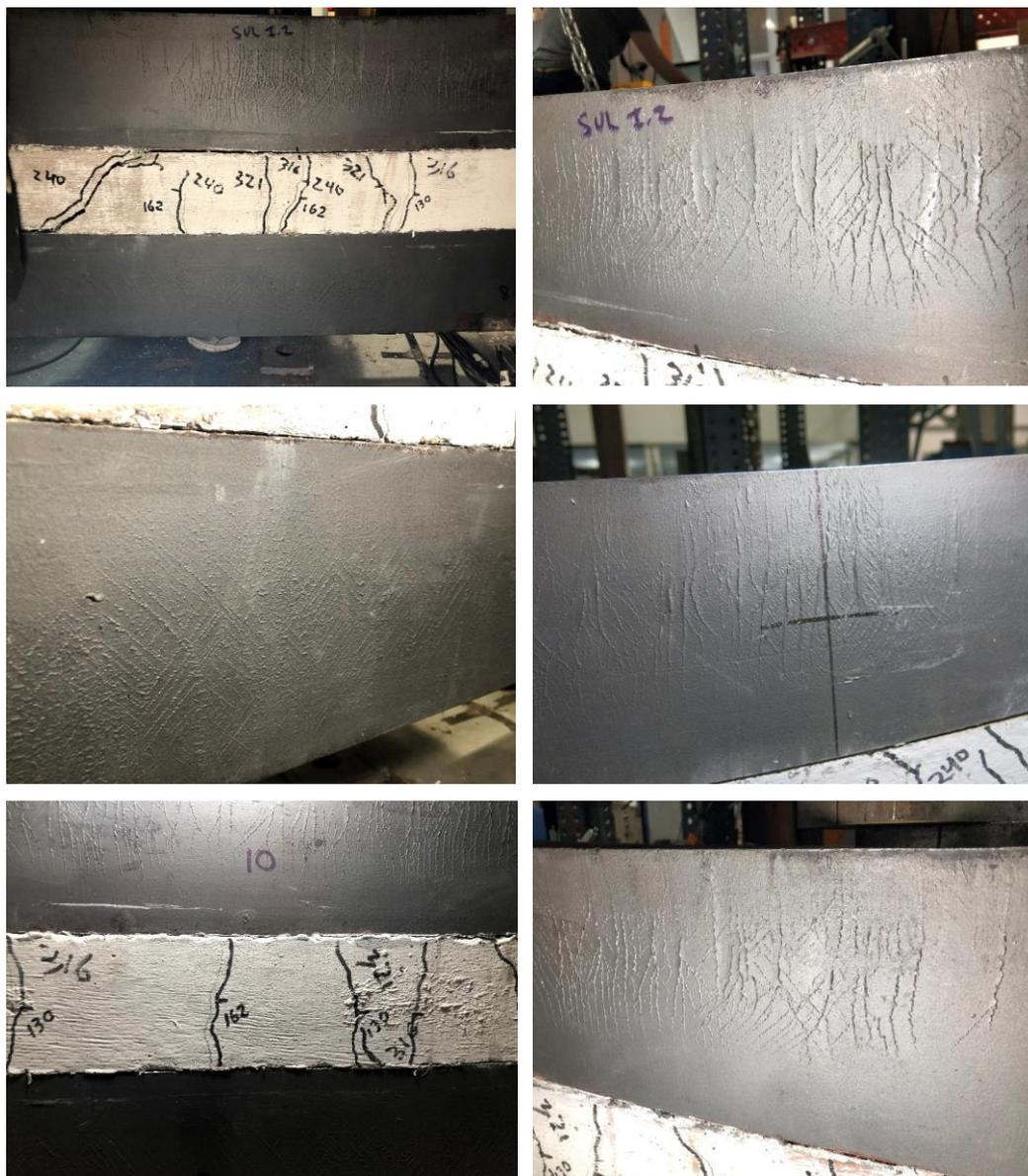
Figura 6.35 - Plastificação das mesas dos perfis de aço do modelo PM-2.
