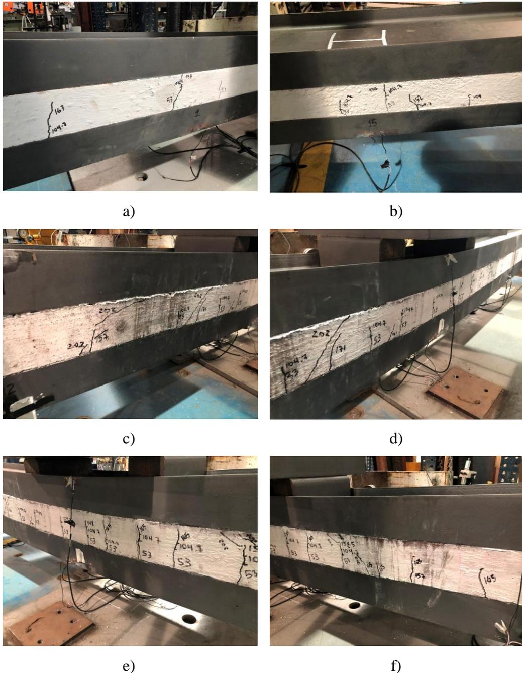
**Figura 6.15 – Fissuração do pilar PM-1: a) e b) região dos conectores das extremidades; c) e d) região centro-sul; e) e f) região centro-norte.**
