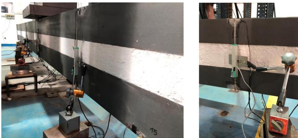
**Figura 4.18 - Transdutores de deslocamento posicionados.**
