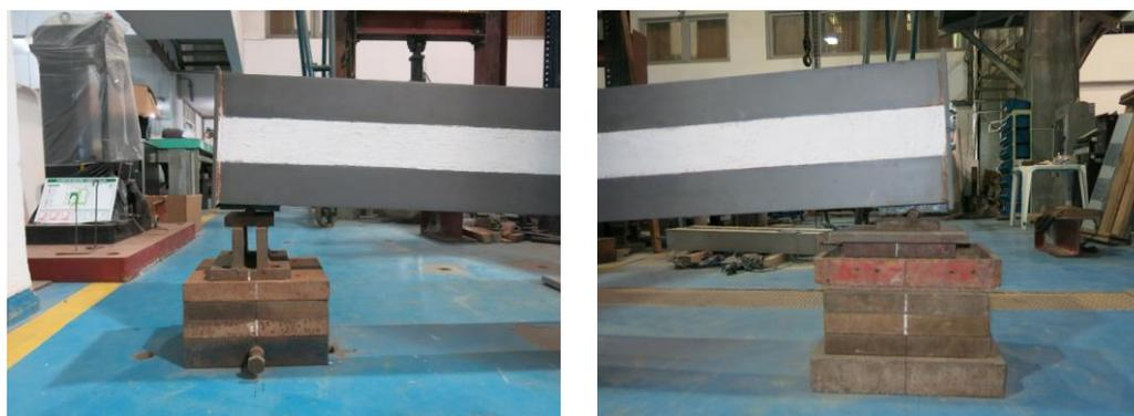
**Figura 6.18 - Posição dos apoios ao término do ensaio de carga para o estado limite último**
