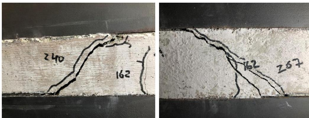
Figura 6.31 - Detalhes das fissuras do PM-2.
