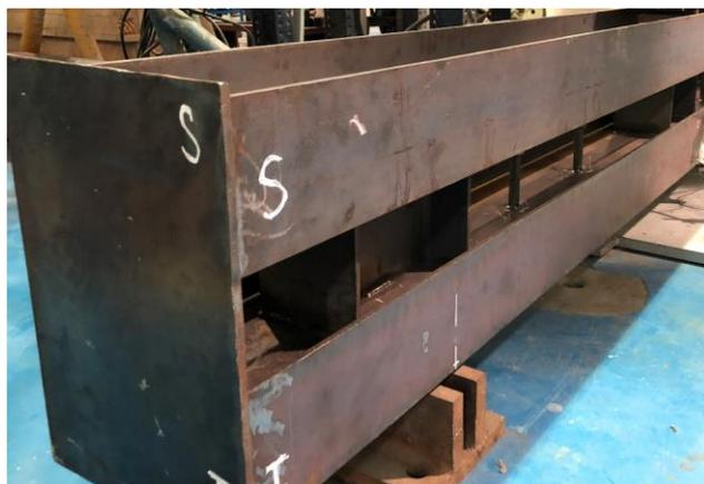
**Figura 4.1 - Parte do pilar PA-1, mostrando os conectores que ligam as almas, os *stud bolts* soldados e a chapa da extremidade.**
