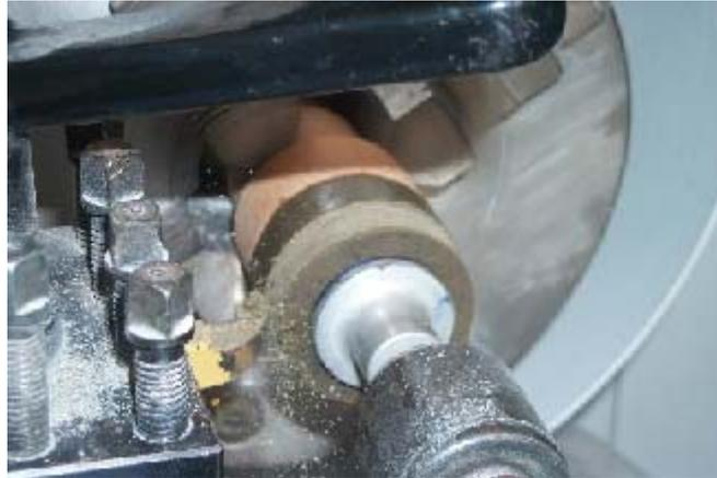
Figura 5. 14 - Corpo de prova de 38,1 mm – CP14 (folhelho B)
