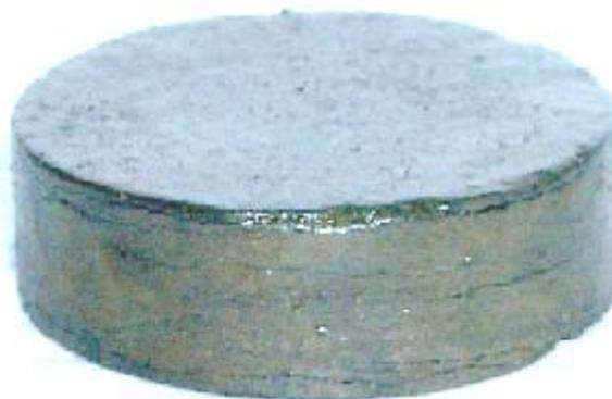
Figura 5. 13 - Detalhe do CP12 (folhelho B) mostrando as fissuras existentes
