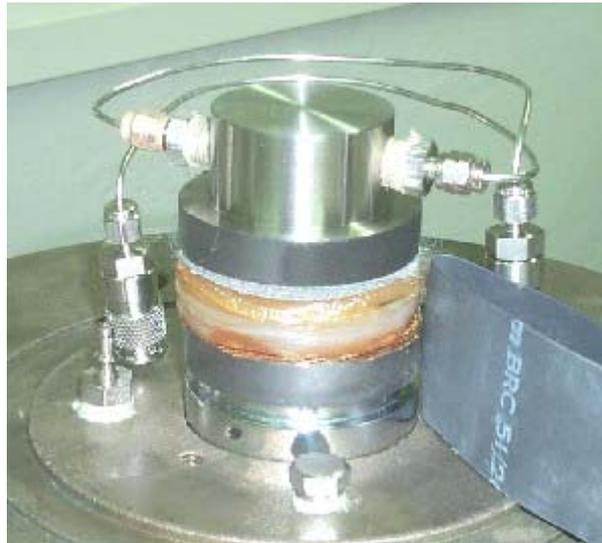
Figura 5. 3– Corpo de Prova sintético instalado entre os “caps” de topo e de base
