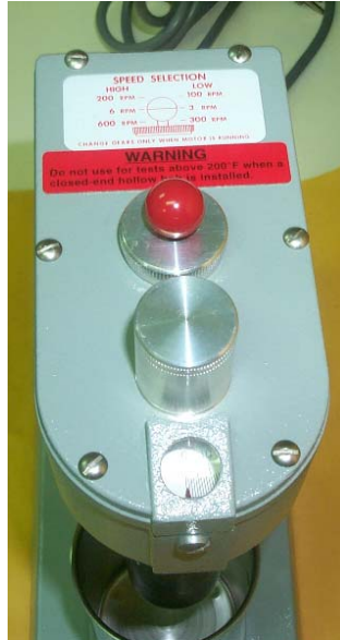
Figura 4. 4 - Detalhe do mostrador para a leitura da deflexão \theta , e também da marcha para controle das velocidades em rpm
