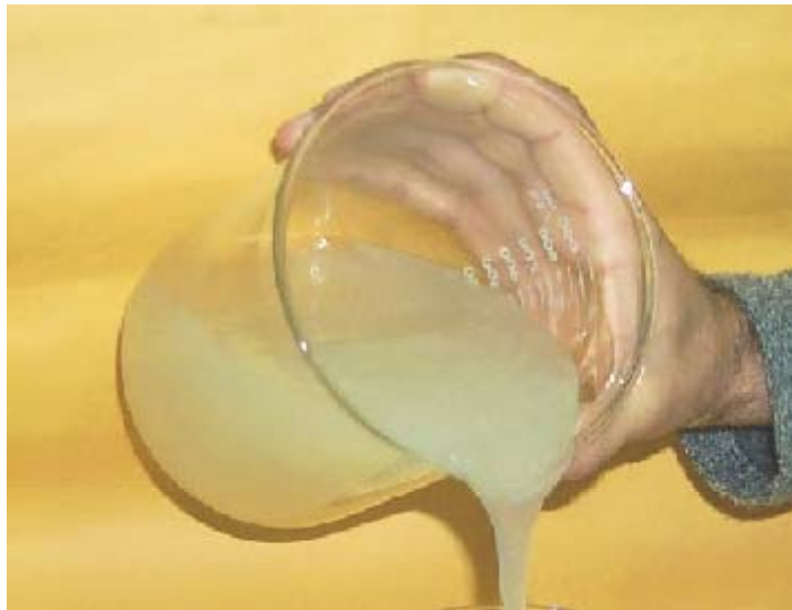
Figura 4. 2 - Fluido goma xantana, HPA e bactericida
