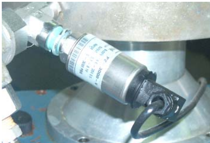
Figura 3. 4 – Transdutores de pressão de 21 MPa
