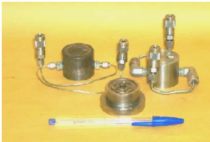
Figura 3. 8 – “Caps” superiores e inferior para corpos de prova de 38,1 mm
