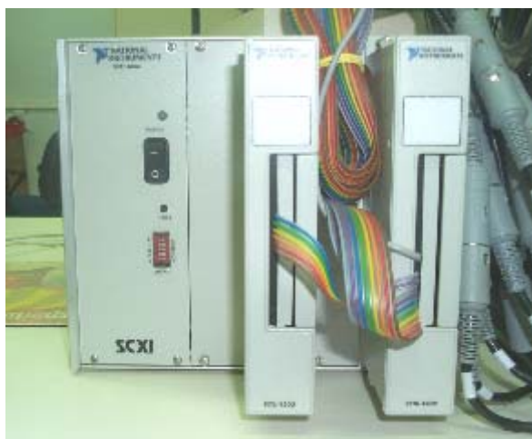
Figura 3. 10 – Condicionador de sinais do sistema de aquisição de dados
