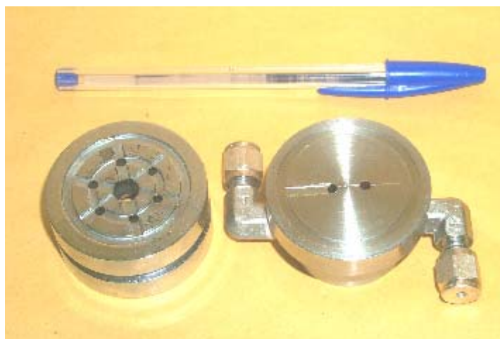
Figura 3. 9 – “Caps” de topo e da base de 50,8 mm
