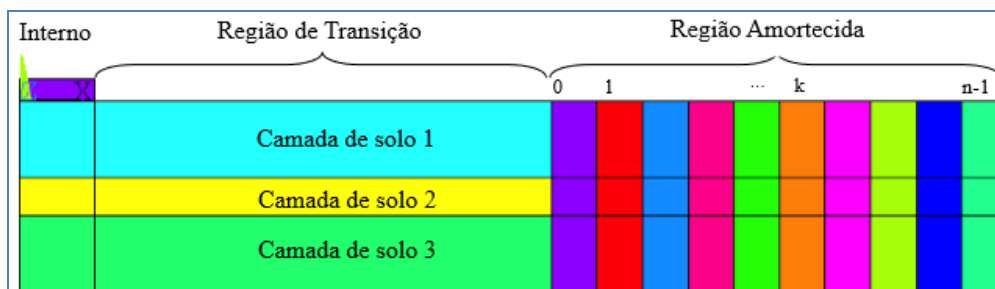
Figura 18: Representação de solo estratificado com contornos de amortecimento geométrico gradual (retirado de Conrado e Gidwani, 2016, adaptado).
