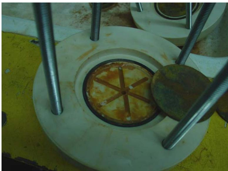
Figura 5.1 – Vista da base da célula edométrica, mostrando a perda de finos.
