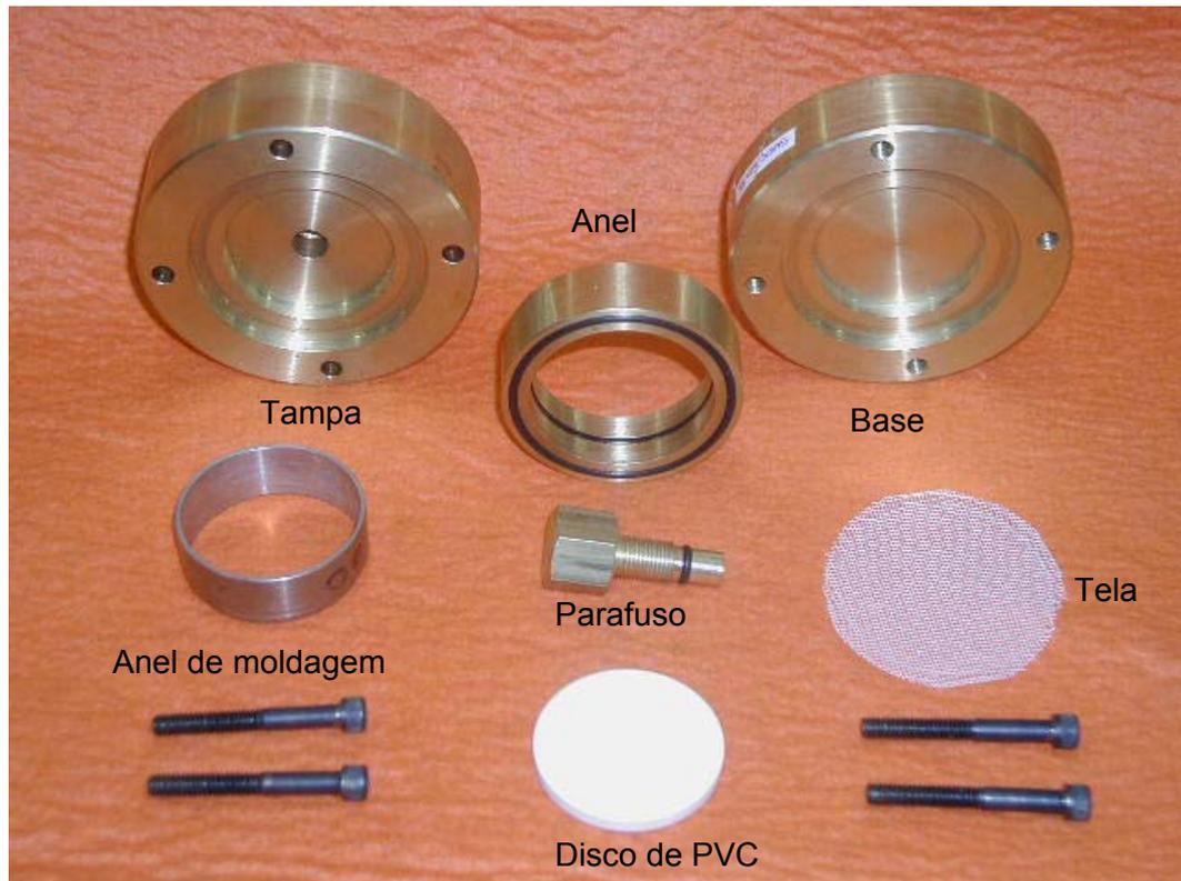
Figura 3-9 – Câmara de Equalização desmontada.
