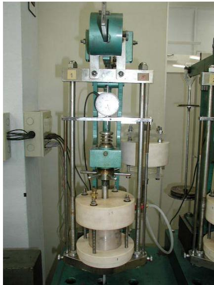
Figura 3-2 – Célula de Adensamento montada
