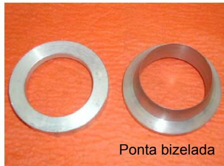
Figura 3-13 – Extensão em latão para moldar corpos de provas.
