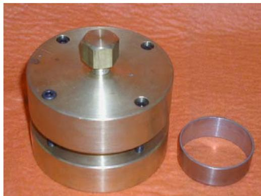
Figura 3-8– Câmara de Equalização montada
