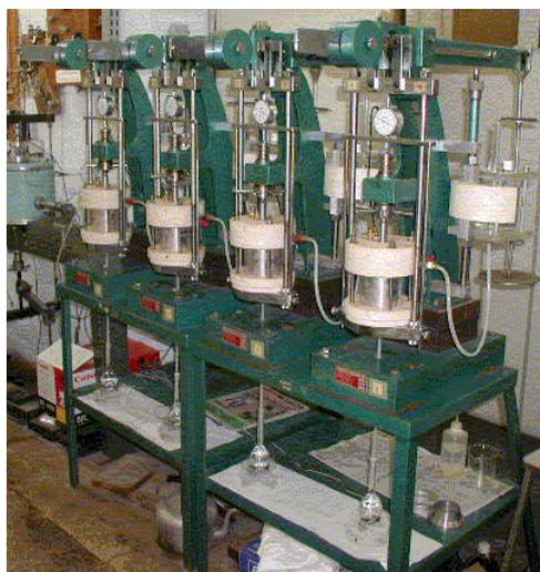
Figura 3-1 - Vista geral do edômetro ADS
