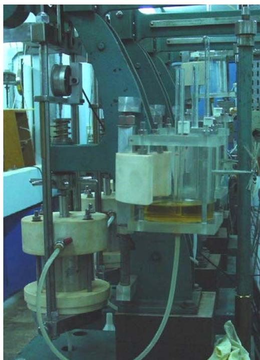
Figura 3-7 – Vista da conexão entre o Mariotte e a célula edométrica.
