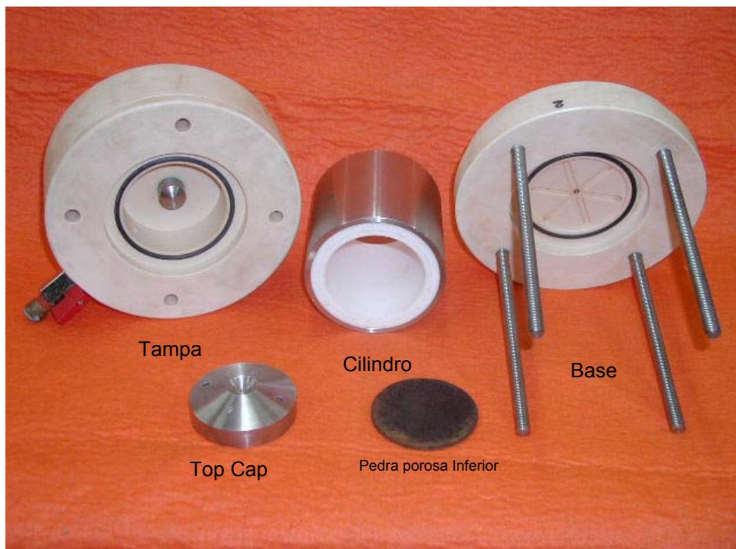
Figura 3-3 – Célula de Adensamento desmontada
