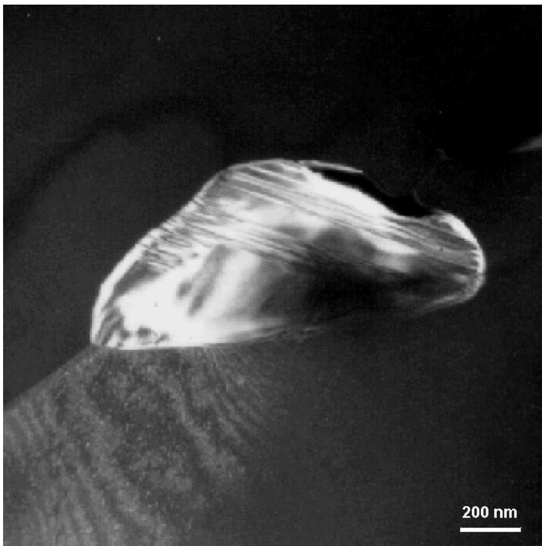
Figura 4.48: Microscopia eletrônica de transmissão em campo claro de precipitado intergranular em amostra envelhecida a 900°C por 100 horas.
