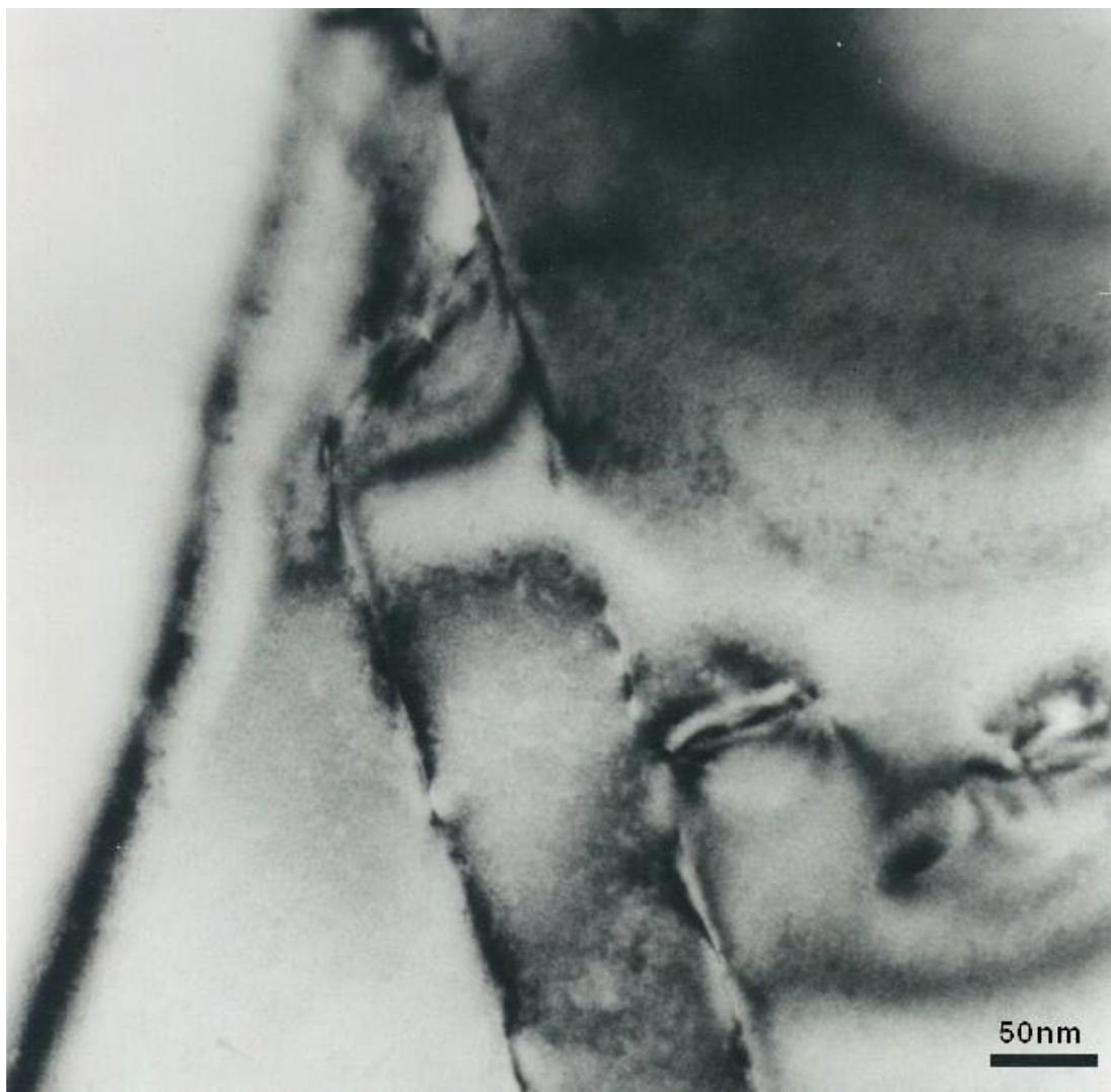
Figura 4.4: Microscopia eletrônica de transmissão, campo claro, de região maclada em amostra no estado de como recebida.
