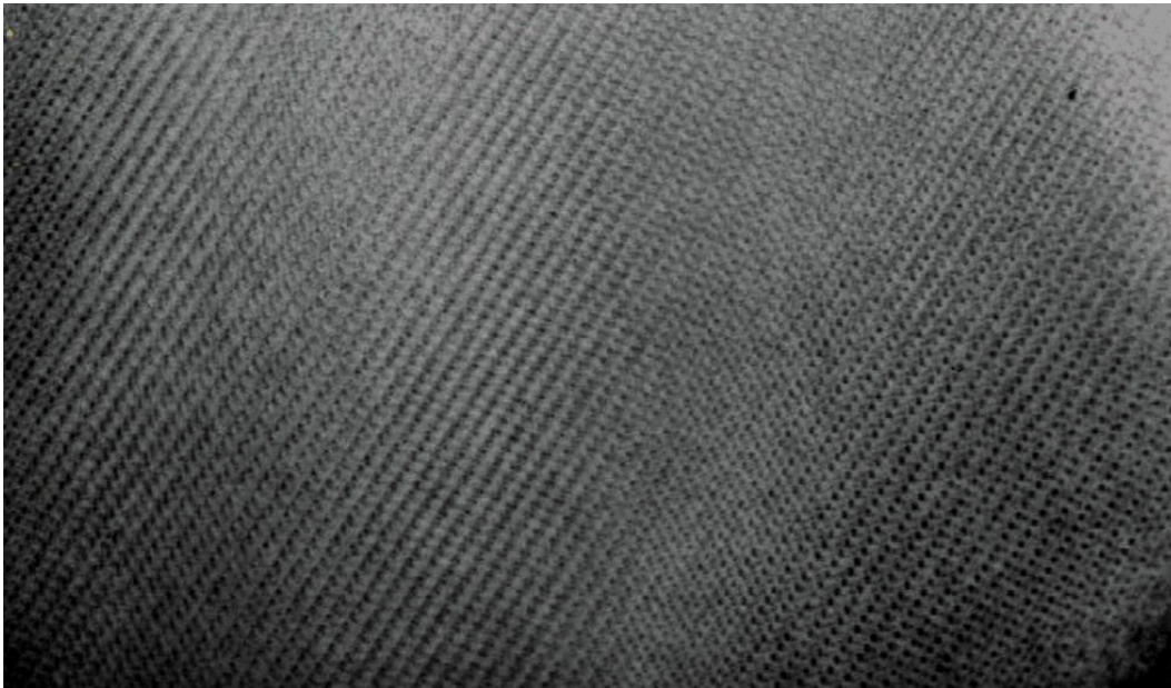
Figura 4.49: Microscopia eletrônica de transmissão, imagem de alta resolução obtida a partir de precipitado intergranular em de amostra envelhecida a 900°C por 100 horas.
