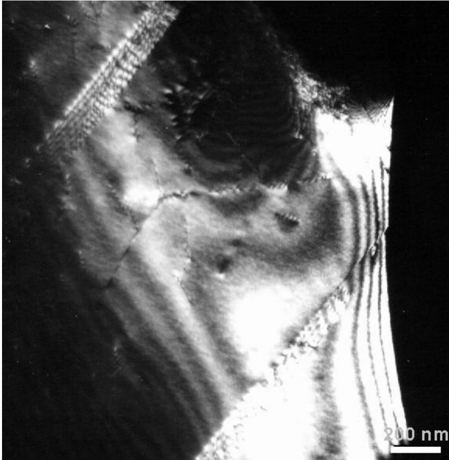
Figura 4.14: Microscopia eletrônica de transmissão em campo claro, mostrando empilhamento de discordâncias.
