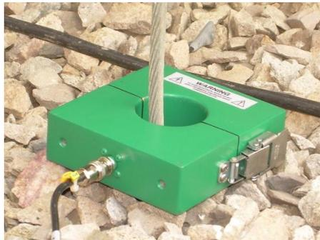
Figura 2.8 – TC de alta frequência conectado ao cabo de aterramento do equipamento
