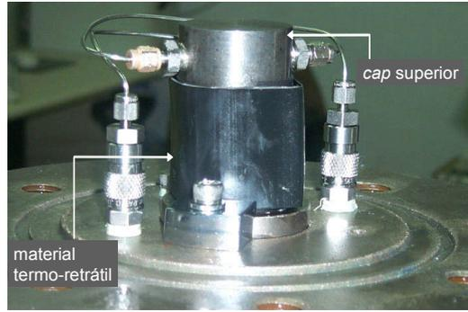
(D) assentamento do cap superior e sistema envolvido por material termo-retrátil
