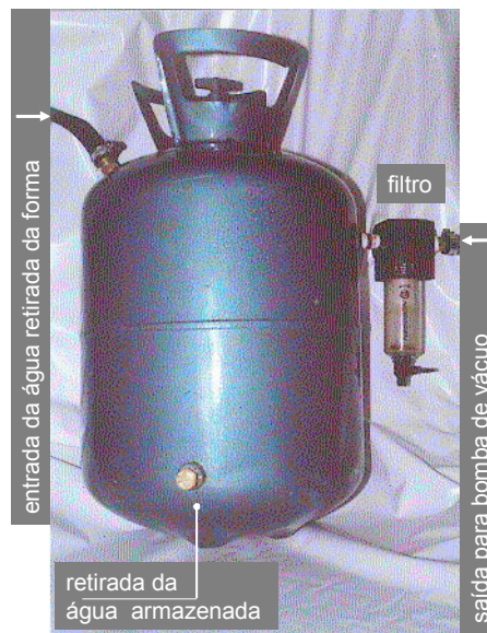
Figura 12: Detalhes do recipiente adaptado para o armazenamento da água retirada durante a moldagem.
