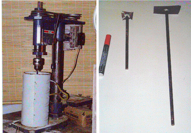
Figura 7: Furadeira de bancada e as hastes com hélice empregadas na dispersão da polpa e mistura do material.
