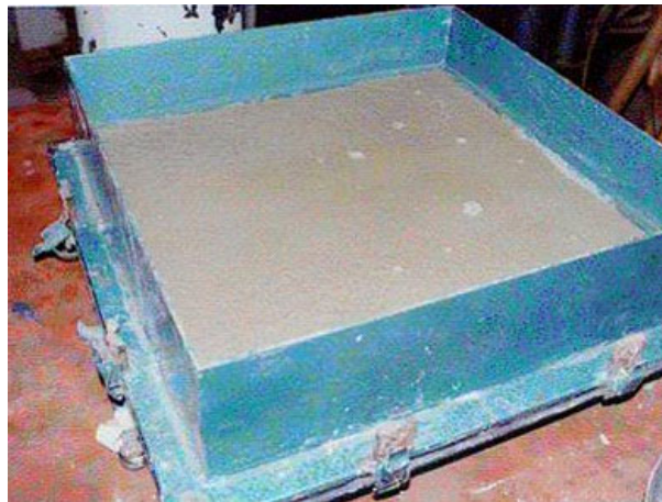
Figura 15: Fase de retirada do excesso de água da mistura através do vácuo
